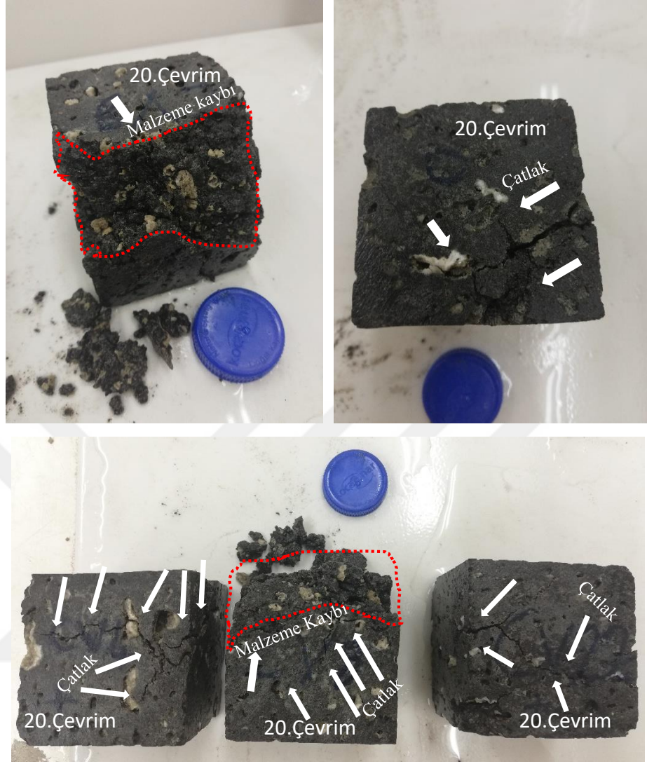
Şekil 6.14 MgSO_4 tuz kristallenmesi deneyi sonucunda örneklerde meydana gelen bozunmalar
