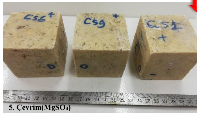
Şekil 6.20 MgSO 4 ile yapılan deney sonunda 1.ve 2. grup kireç taşı örneklerinde oluşan renk değişimi
