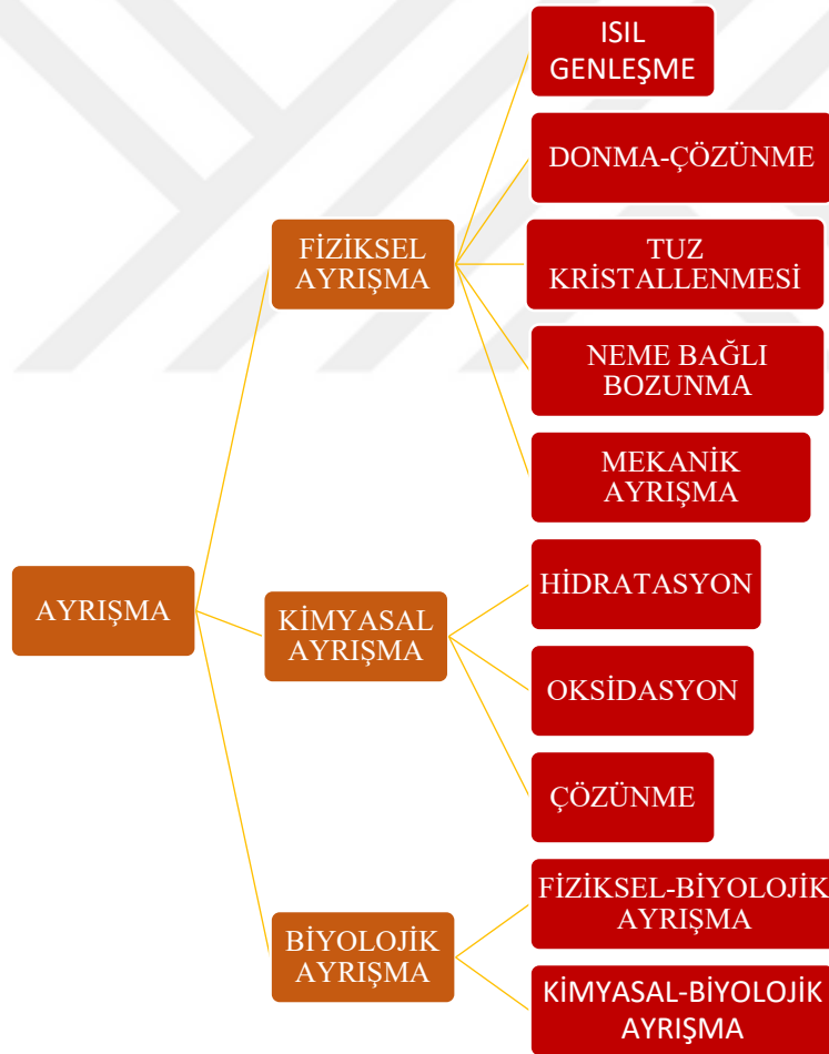
Şekil 1.11 Yapı taşlarının bozunmasına neden olan ayrışmaların sınıflandırması
