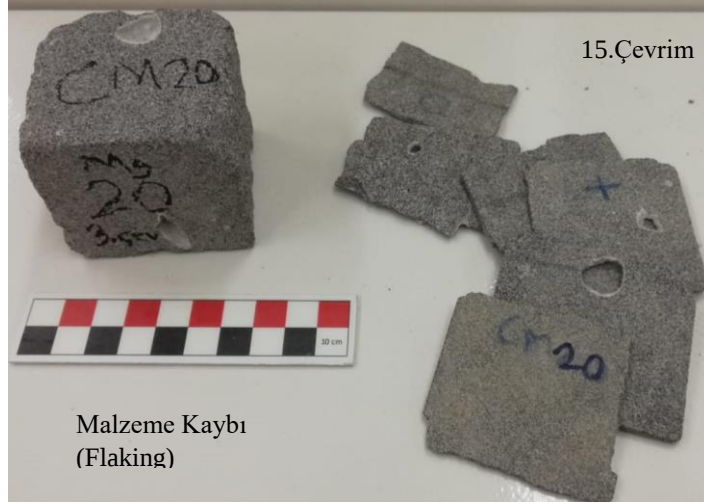
Şekil 6.16 MgSO_4 tuz kristallenmesi deneyi sonucunda masif bazalt örneklerinde meydana gelen bozunma
