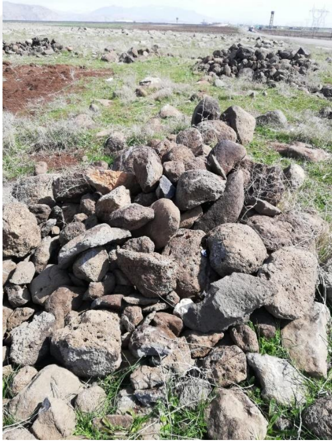
Şekil 3.3 Masif ve veziküler bazalt örneklerinin alındığı bloklar
