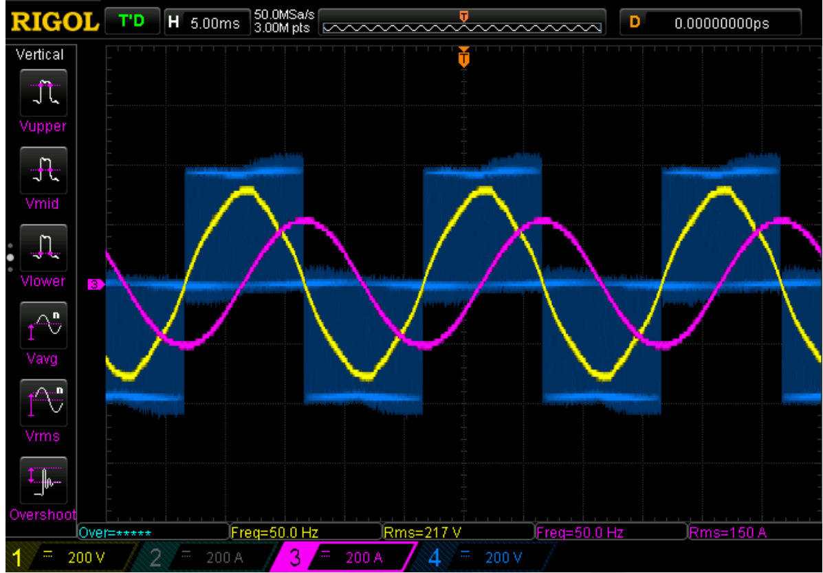
Şekil 4.10: Si-NPC evirici yapısına ait çıkış gerilim ve akım dalga şekilleri (Mavi: Evirici çıkış gerilimi, Sarı: Şebeke gerilimi, Mor: Evirici akımı)
