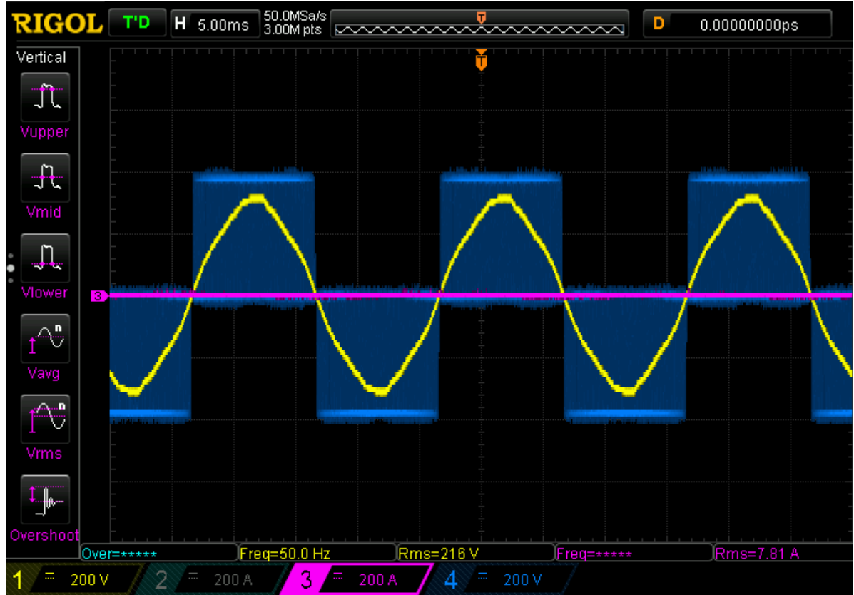
Şekil 4.9: Evirici çıkış ve şebeke gerilimlerine ait dalga şekilleri (Mavi: Evirici çıkış gerilimi, Sarı: Şebeke gerilimi, Mor: Evirici akımı)
