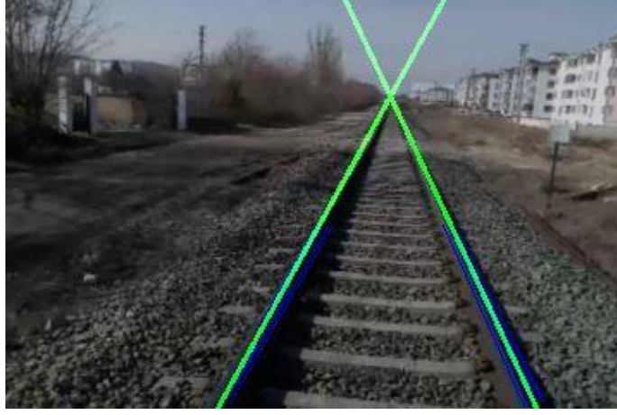
Şekil 3.3. Sağ ve sol çizgilerin oluşturulması
