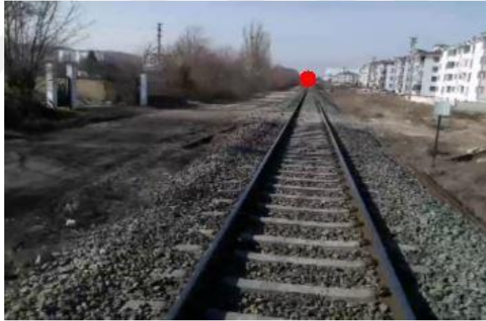
Şekil 3.4. Ufuk noktasının kırmızı nokta ile işaretlenmesi
