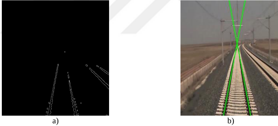
Şekil 2.10. a) Görüntüye uygulanan kenar çıkarma sonucu b) Hough Dönüşümü
