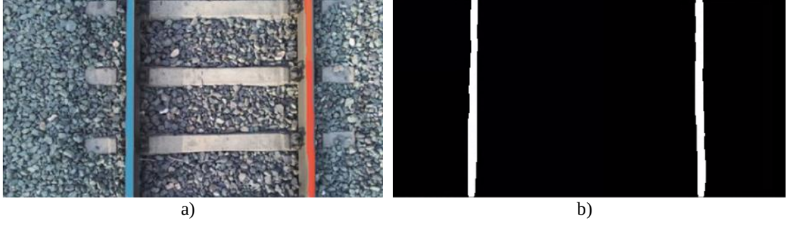
Şekil 2.24. Sonuçlar a) Maskelerin elde edilmesi b) İkili maskenin oluşturulması
