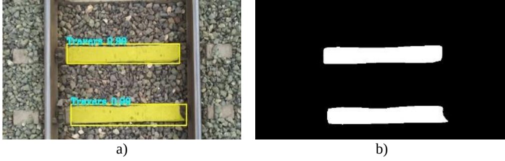
Şekil 2.31. Mask R-CNN sonucu elde edilen görüntü a) Maske, kutu, etiket bilgisi b) İkili maske
