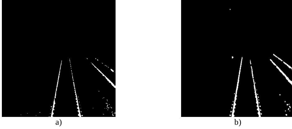
Şekil 2.9. a) Eşikleme işlemi sonucu b) Morfolojik işlemler sonucu
