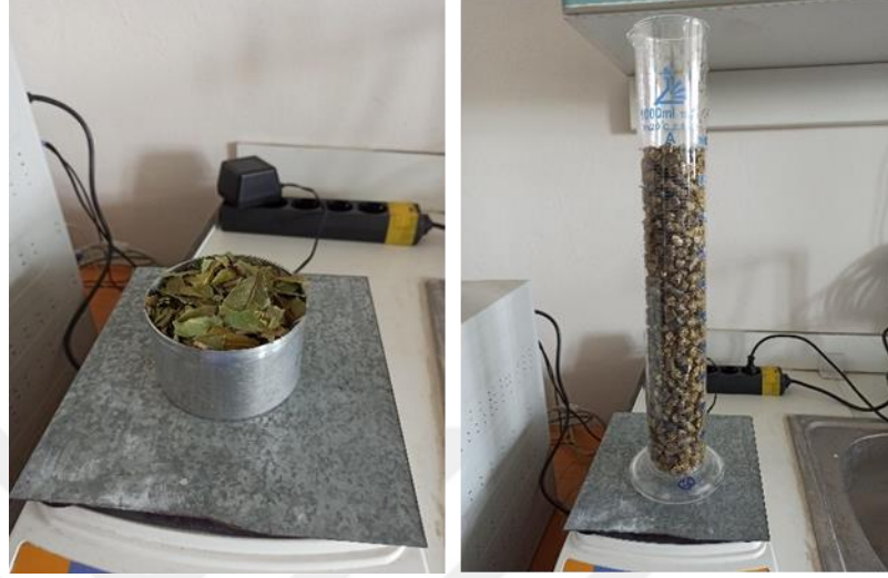
Şekil 3.8. Ham materyal ve peletlerin yığın yoğunluğu ölçümü
