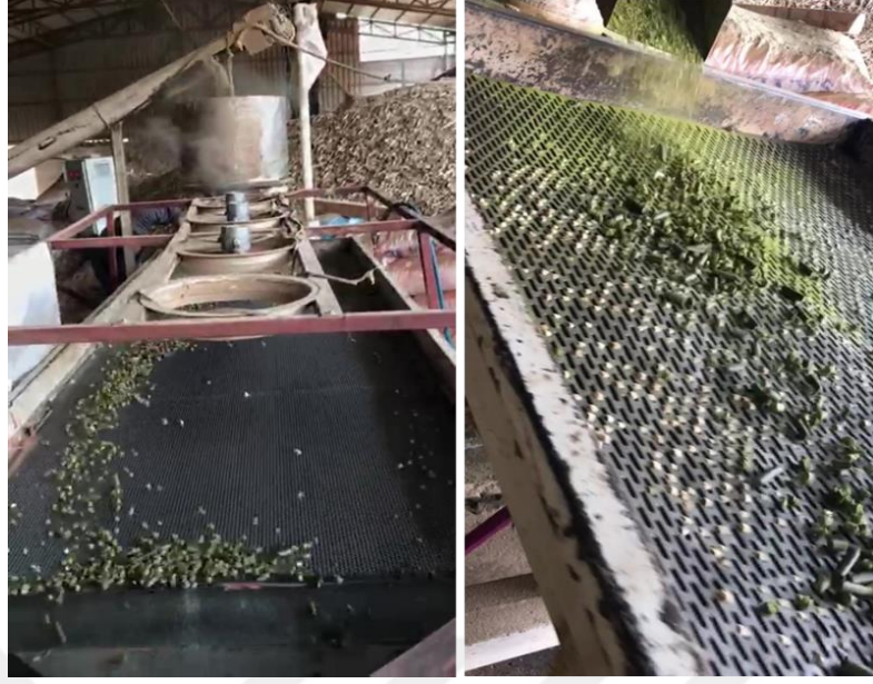
Şekil 3.4. Pelet eleme ve soğutma bölümü
