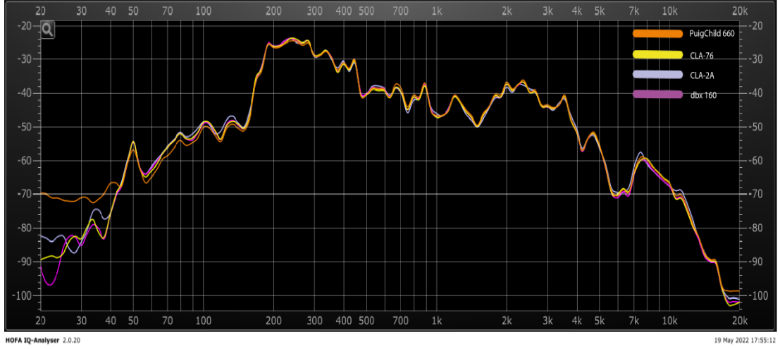
Şekil 3.178 Caz Müzik, Kompresör Uygulanmış Elektro Gitar Frekans Spektrumu (LTAS)
