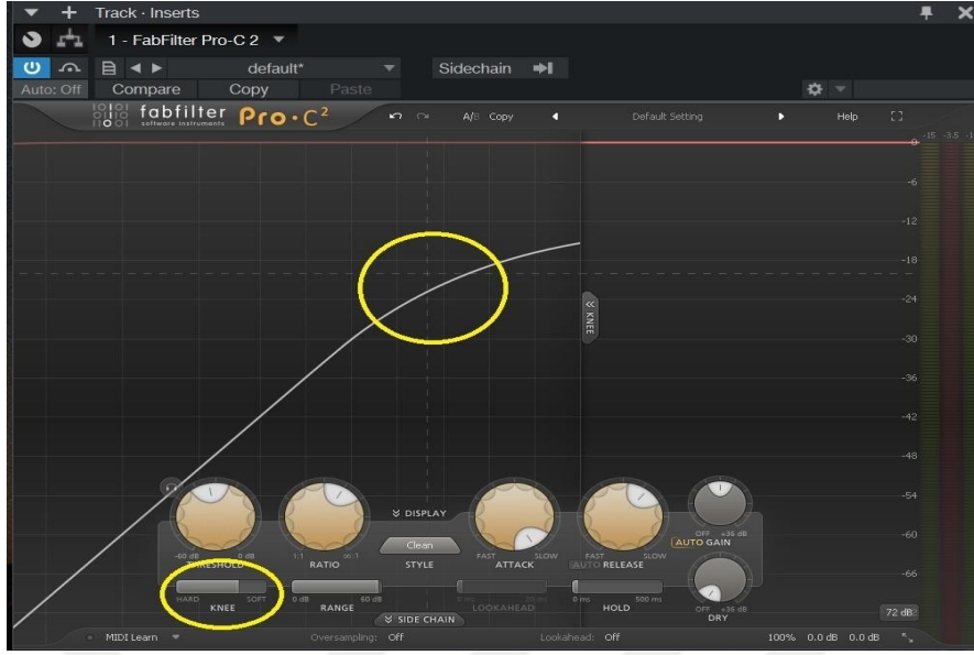
Şekil 2.10 FabFilter Pro C-2 Soft Knee Görüntüsü
