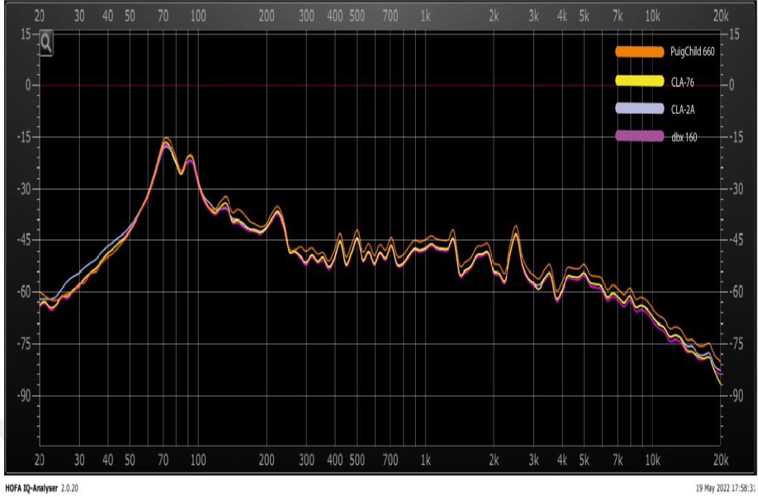
Şekil 3.185 Geleneksel Müzik, Kompresör Uygulanmış Perküsyon Grubunun Frekans Spektrumu (LTAS)
