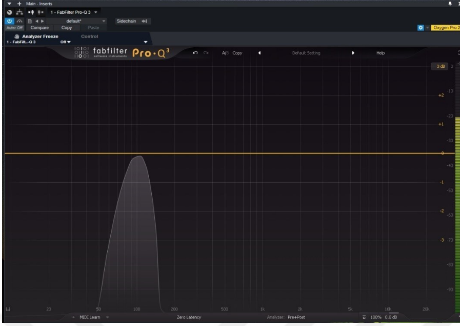
Şekil 3.2 100 Hz Sinüs Dalgasının FabFilter Pro-Q3 Analizör Ekranındaki Görüntüsü
