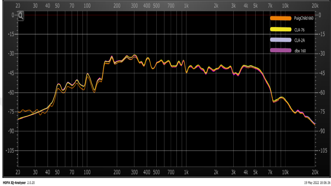
Şekil 3.182 Rock Müzik, Kompresör Uygulanmış Elektro Gitar Frekans Spektrumu (LTAS)
