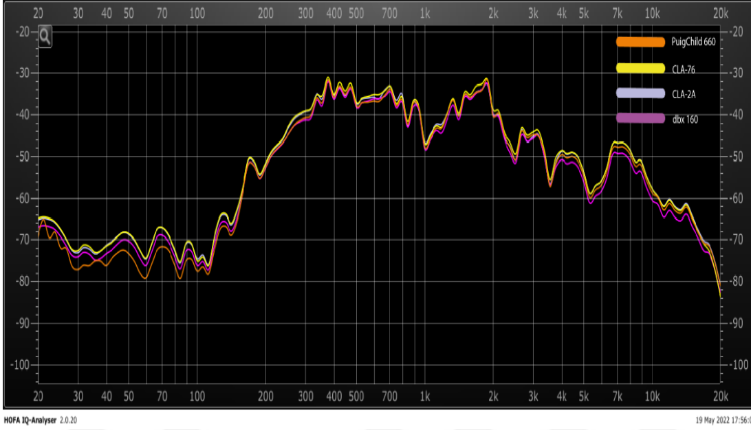
Şekil 3.179 Caz Müzik, Kompresör Uygulanmış Vokal Frekans Spektrumu (LTAS)
