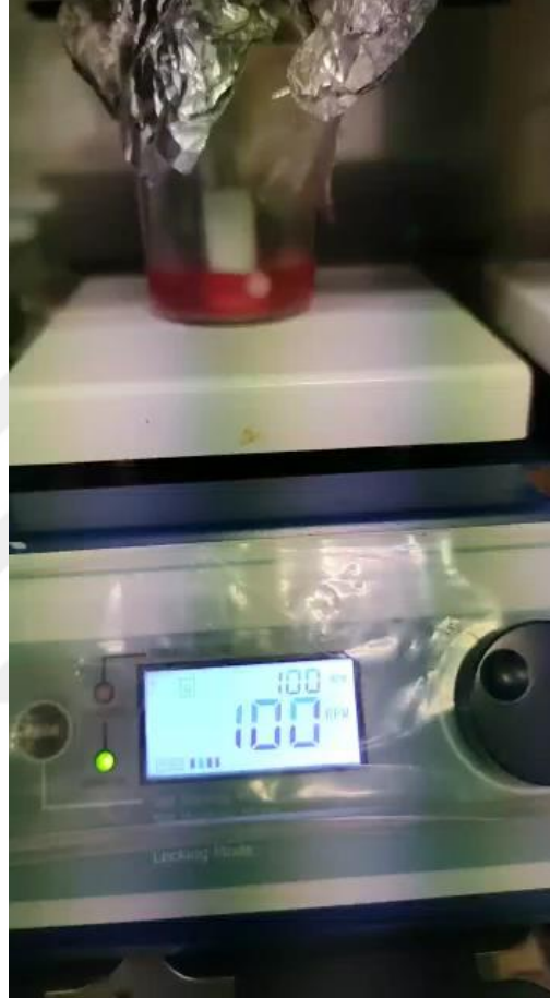
Şekil 4.7 Spinner flaskın ideal karışma hızı
