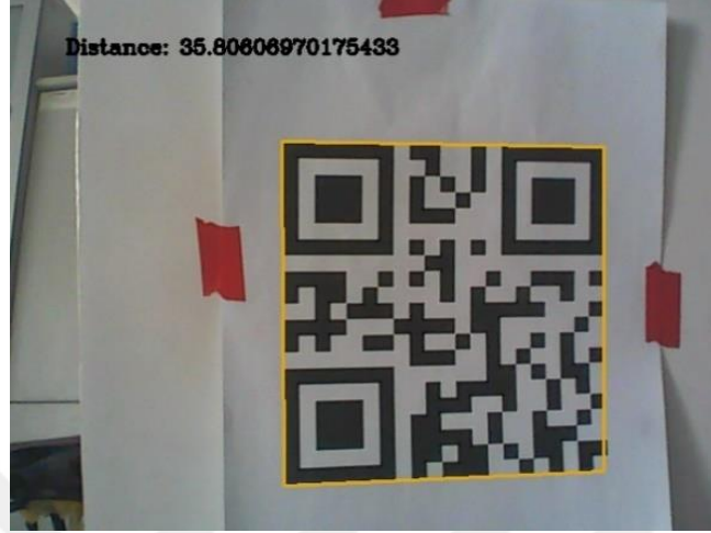
Őekil 3.20 QR koddan mesafe deęiřkeninin elde edilmesi
