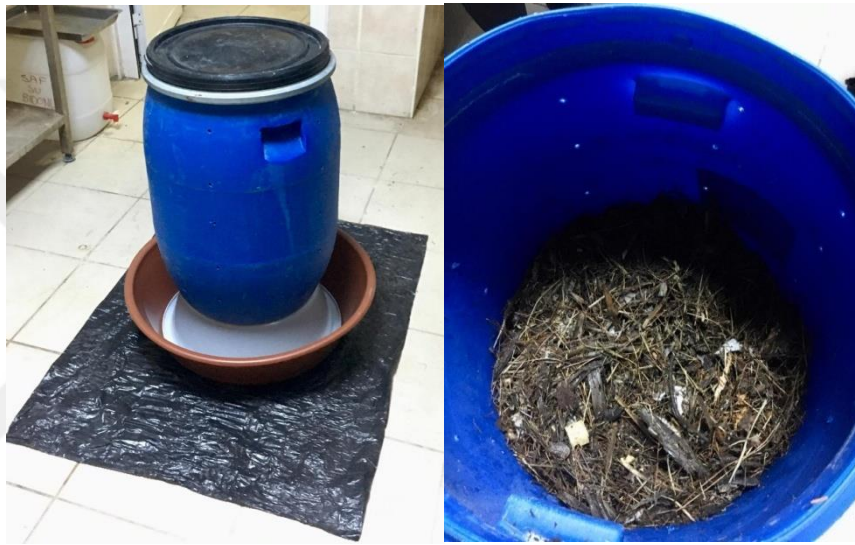
Şekil 2.1: Bidon kompost düzeneği.
