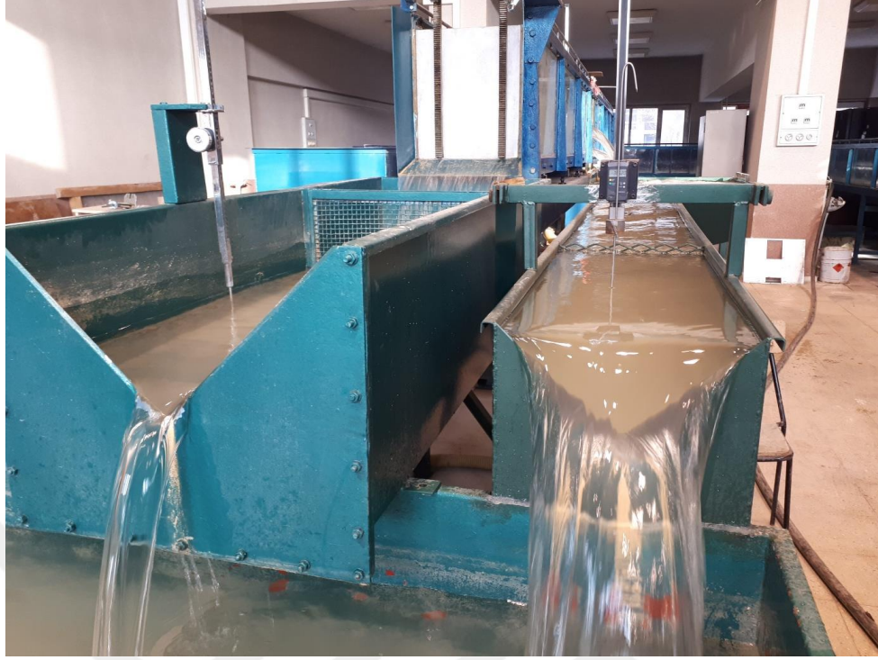
Şekil 4.5. Deneyel çalışmada kullanılan yaklaşım kanalı ve doğrusal çıkış kanalı
