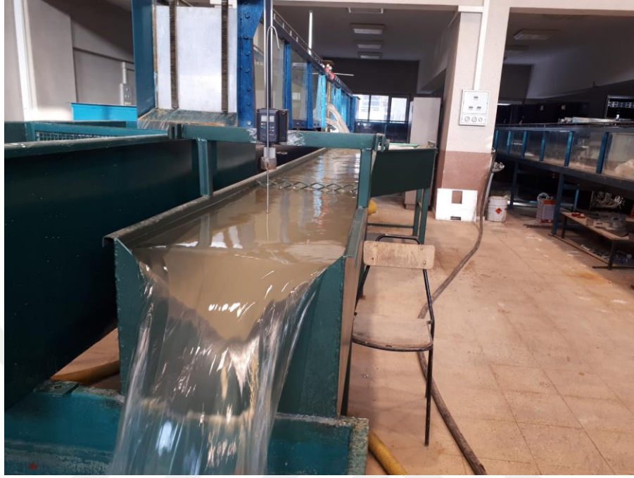
Şekil 4.8. Deneysel çalışmada kullanılan toplama kanalı
