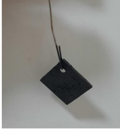
Resim 5.2 NaOH ile korozyona uğrayan Al. 2024.
