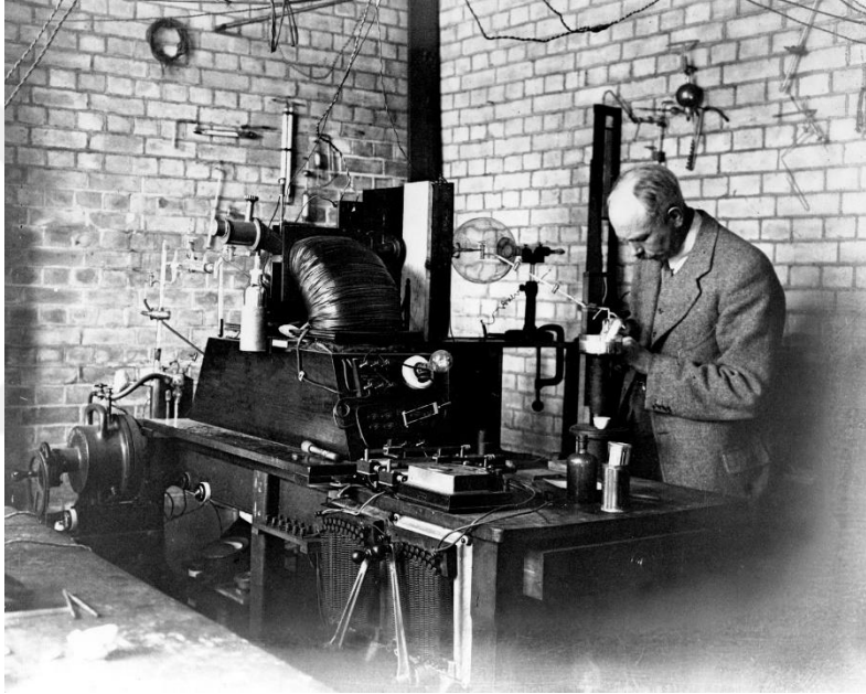
Resim 2. Francis W. Aston ve 1919'da tasarlanan Cambridge Üniversitesi Cavendish Laboratuvarı'ndaki ilk kütle spektrograf.
