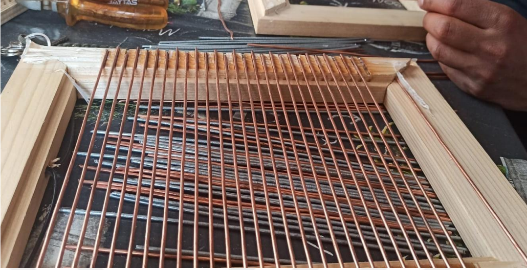
Şekil 3.1. Toplayıcılara tel materyal takılması işlemi.
