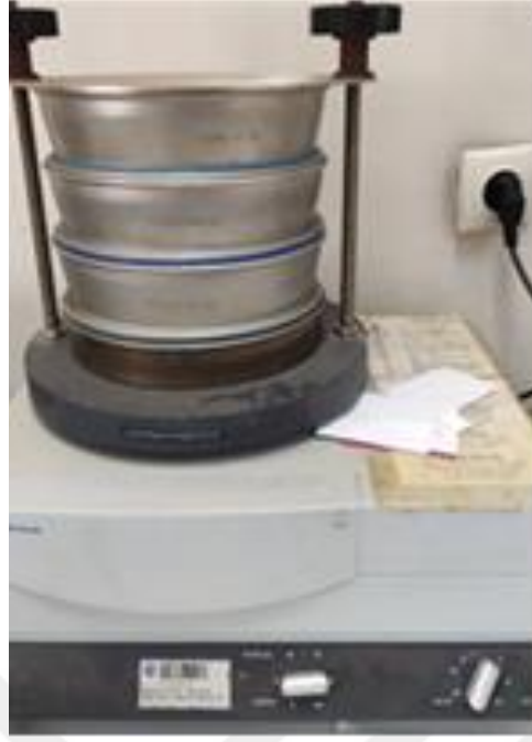
Şekil 4.5 Elek sarsma cihazı
