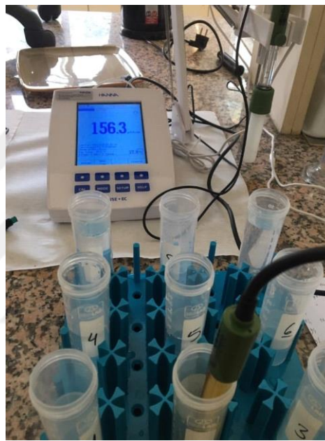
Şekil 2.5. Örneklerde yapılan nitrat analizi
