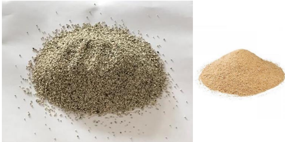
Şekil 2.2. Çalışmada kullanılan zeolit ve talaş materyalleri
