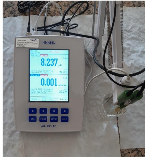
Şekil 2.3. Çalışmada kullanılan pH, ISE ve EC metre
