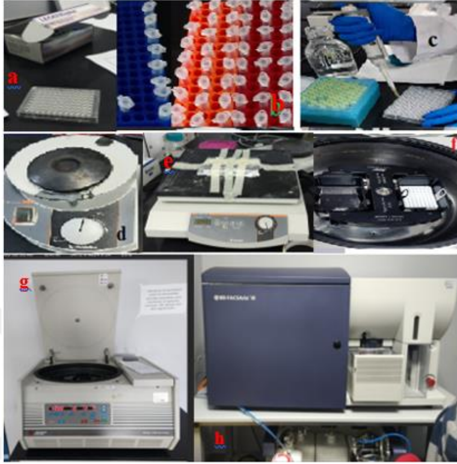
Şekil 3.38. Sitokin Kit Analizinde kullanılan malzemeler (Lehamann, 2017): a -V Bottom Plate, b -Örnekler ve standart solüsyonlar c -Plate içine örneklerin konulması d - Vorteks karıştırıcı e - Plate shaker cihazı f -Santrifüj cihazının iç görüntüsü g - Santrifüj cihazı, h -Flow stometre cihazı (BD FACS Area III) (Lehamann, 2017; Biolegend Sitokin Kit Kataloğu, 2020).
