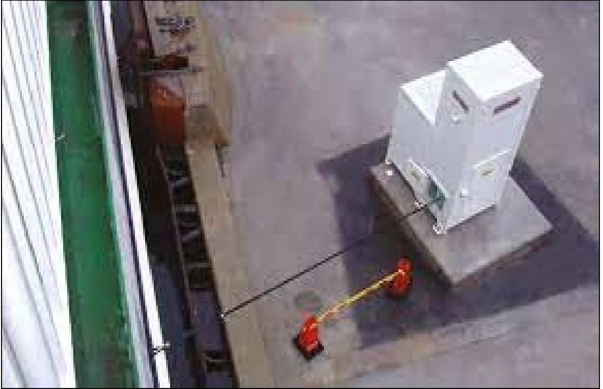
Şekil 28. Otomatik Gemi/Rıhtım Yanaşma Sistemi (Kıyı) (URL-13, 2022)
