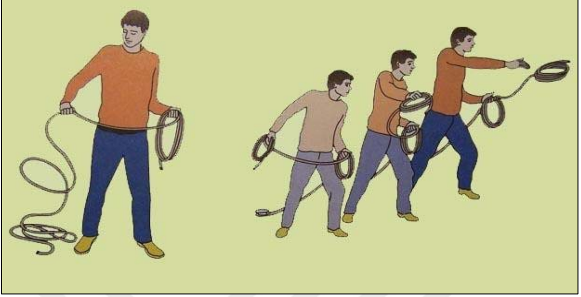
Şekil 6. El incesinin hazırlanması (MEGEP, 2015).
