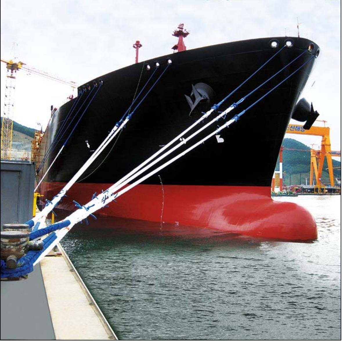
Şekil 21. 3 Baş Halat 2 Açmaz 4 Spring Halat vermiş dökme gemisi (URL-7, 2022).
