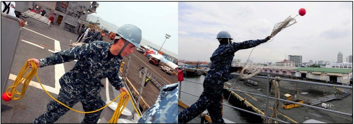
Şekil 7. El incesini rıhtıma fırlatma (MEGEP, 2015).
