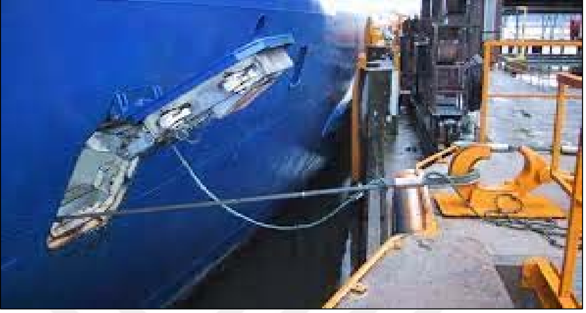
Şekil 29. Otomatik Gemi/Rıhtım Yanaşma Sistemi (Gemi) (URL-13, 2022)
