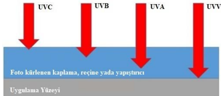
Şekil 2.9. Işık dalga boyunun kürleme kalınlığına etkisi
