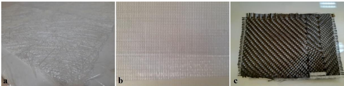
Şekil 3.6. Çalışmalarda kullanılan elyaf takviye malzemeleri (a: keçe cam elyaf, b: çok yönlü kıvrımsız cam elyaf, c: dokuma karbon elyaf)
