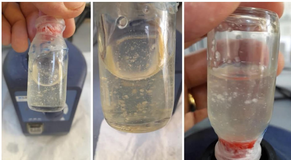
Şekil 4.7. Epoksi reçine formülasyonunun heterojen karışımı
