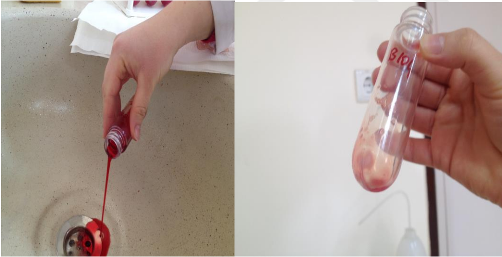
Şekil 3.2.2.6: Üst sıvının dökülmesi
