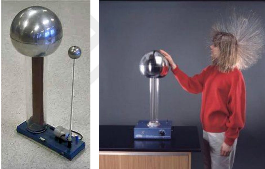
Resim 2.3. (a) ,Triboelektrik etki düzeneği (b) Triboelektrik etkinin bir sonucu
