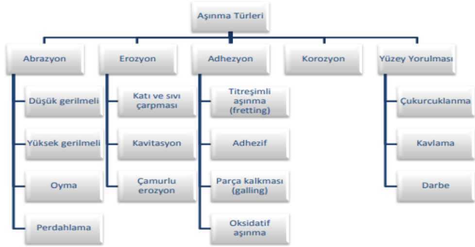
Şekil 2.11. Aşınma türleri ve sınıflandırılması (Mert, 2007)
