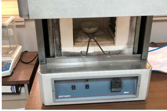
Şekil 5.4. Katalistin kül fırınında kalsine etme işlemi
