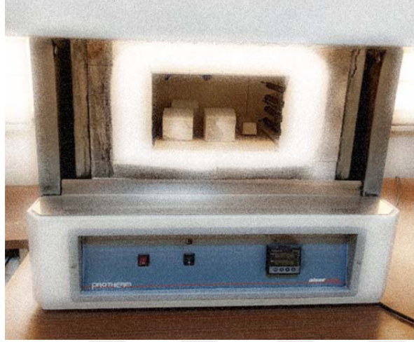
Şekil 5.8. Katalistlerin kül fırınında kalsine işlemi
