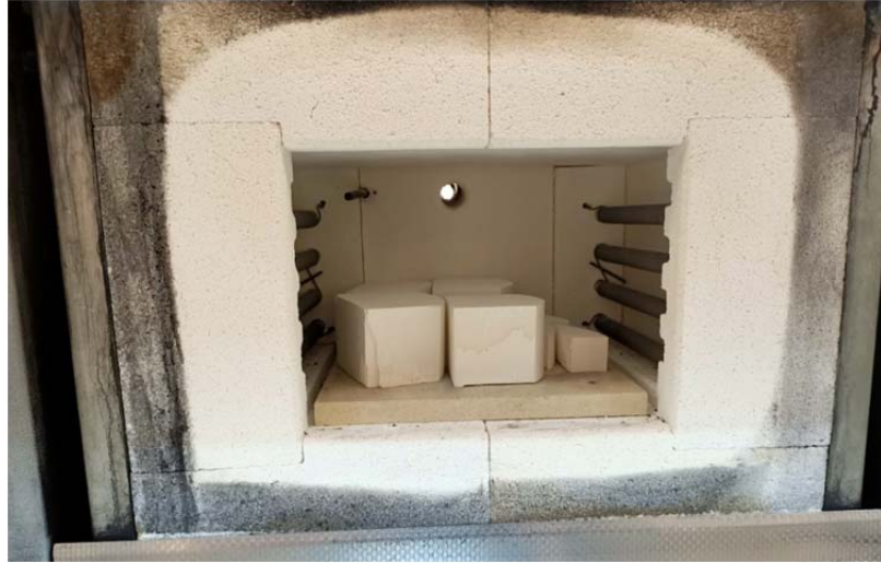
Şekil 5.2. Kordiyerit mazlemelerin kalsine işlemi
