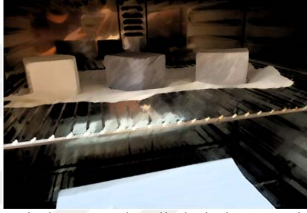
Şekil 5.7. Daldırma işleminden sonra katalistlerin kurutma işlemi
