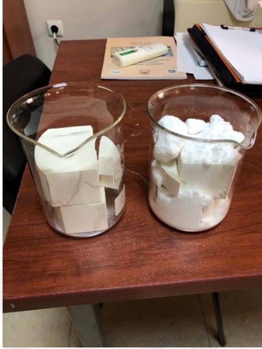
Şekil 5.1. Asit ile kordiyerit malzemenin muamele işlemi
