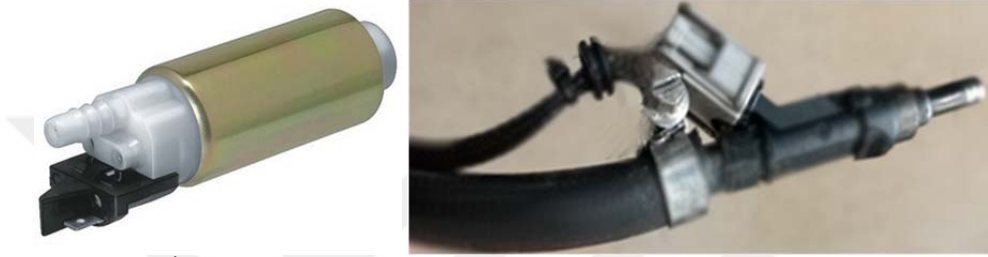
Şekil 5.21. İndirgeyici püskürtme pompa ve enjektörü
