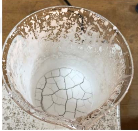
Şekil 5.3. Etüv fırınında kurutulan katalist kimyasal çözeltisi
