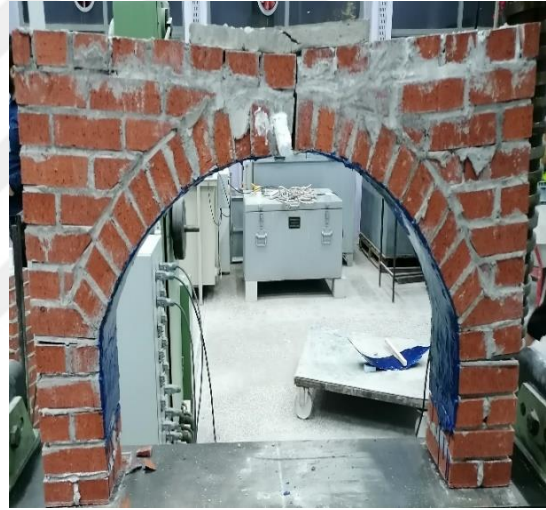
d) Kemerin göçme durumu
