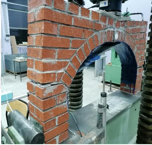
d) Kemerin göçme durumu
