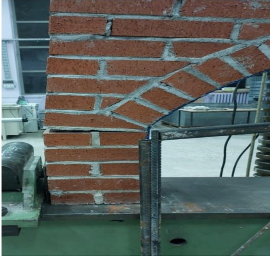
a) Üzengi taşı seviyesinde ayrılma (sol ayak)
