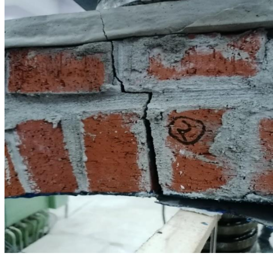
b) Kilit taşı seviyesinde ayrılma
