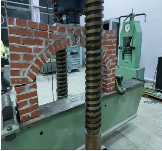
a) Kemerin göçme durumu
