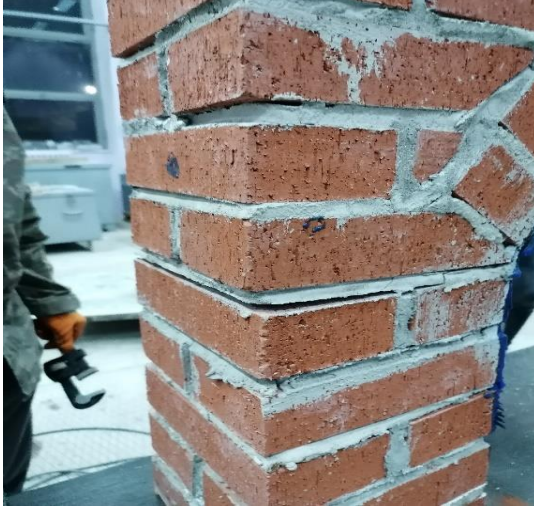
a) Üzengi taşı seviyesinde ayrılma (sol ayak)
