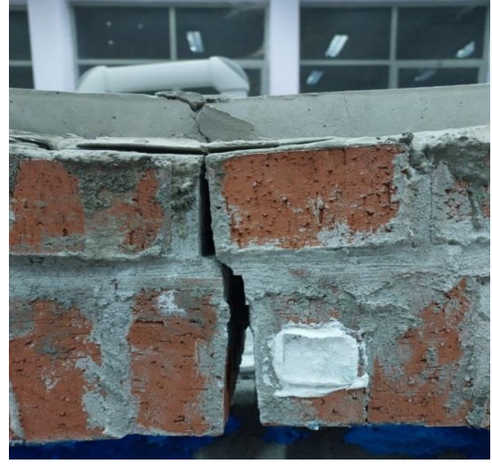
b) Kilit taşı seviyesinde ayrılma
