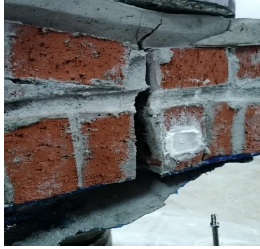
b) Kilit taşı seviyesinde ayrılma
