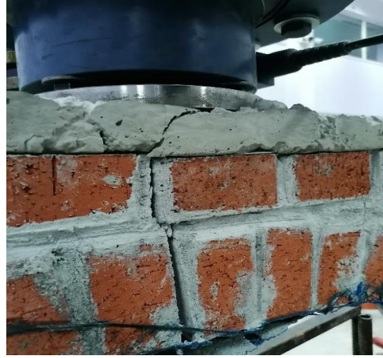
b) Kilit taşı seviyesinde ayrılma
