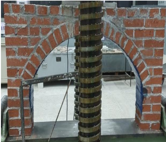
c) GFRP uygulanmış kemer numunesi
