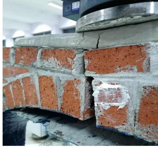
b) Kilit taşı seviyesinde ayrılma
