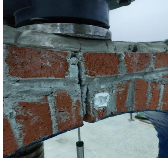
b) Kilit taşı seviyesinde ayrılma
