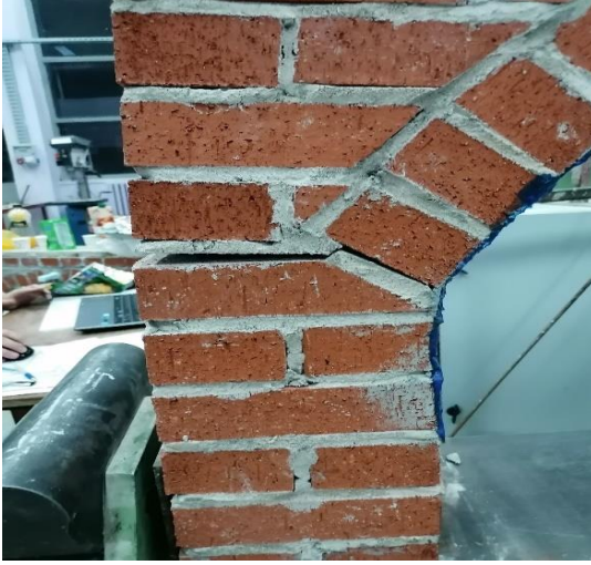
a) Üzengi taşı seviyesinde ayrılma (sol ayak)
