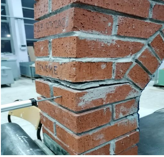
a) Üzengi taşı seviyesinde ayrılma (sol ayak)
