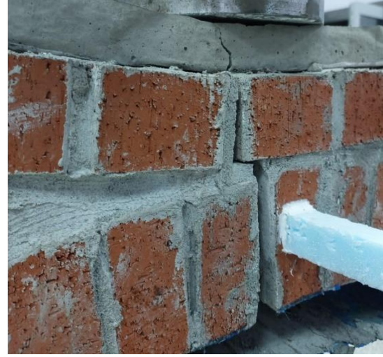
b) Kilit taşı seviyesinde ayrılma
