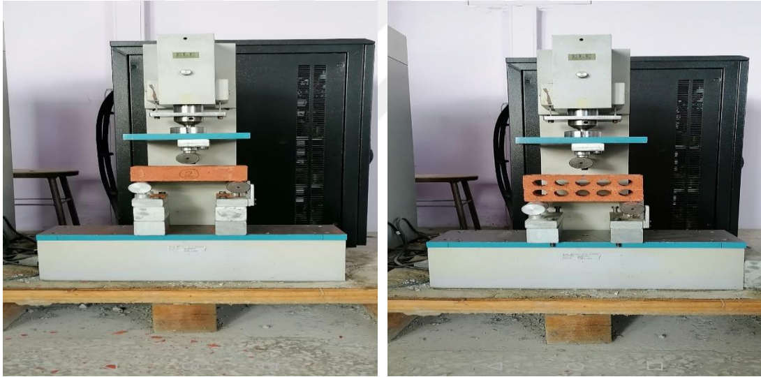
Şekil 5.5. Pres tuğlanın deliğe paralel ve deliğe dik yönde eğilmede çekme dayanım deneyleri
