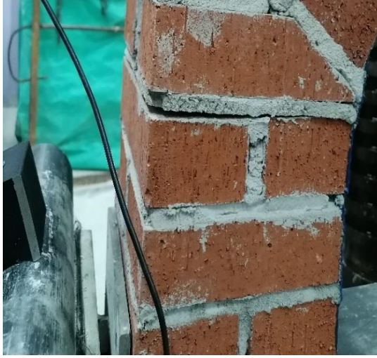
a) Üzengi taşı seviyesinde ayrılma (sol ayak)
