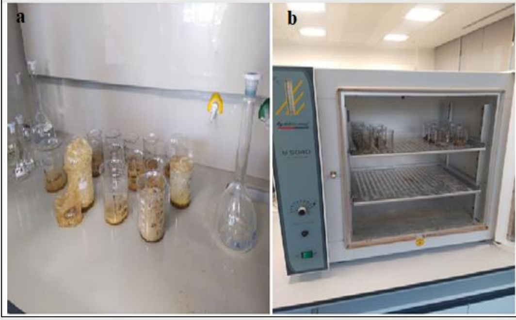
Şekil 3.3.1 Tane boyu analizi laboratuvar çalışması sırasında örneklerin hazırlanma (a) ve kurutma (b) aşamalarından görüntüler
