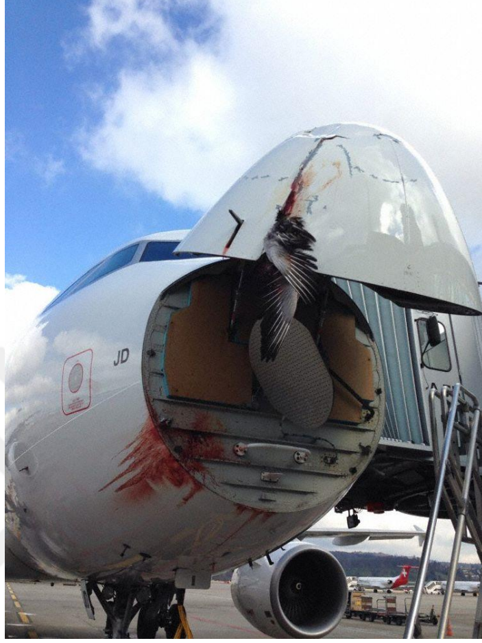
Şekil 1.1 Kuş Çarpması A320-200
