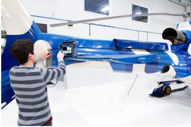
Şekil 27 Hava aracı üzerinde gerçekleştirilen C-Scan örneği
