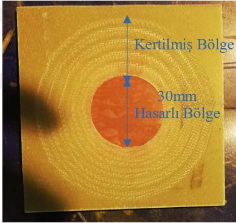
Şekil 6 Tamir için hazırlanan numune örneği
