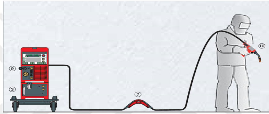
Şekil 3.5 : Manuel CMT(Soğuk Metal Transferi) sistem konfigürasyonu [33].
