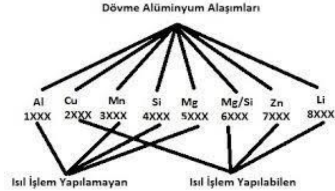
Şekil 2.6 : Döküm alüminyum alaşımlarının alaşım elementlerinin gösterimi.
