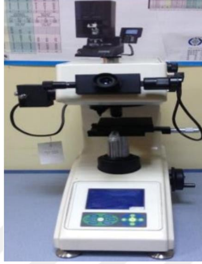
Şekil 4.7 : Mikrosertlik ölçümlerinde kullanılan Vickers sertlik ölçme cihazı.
