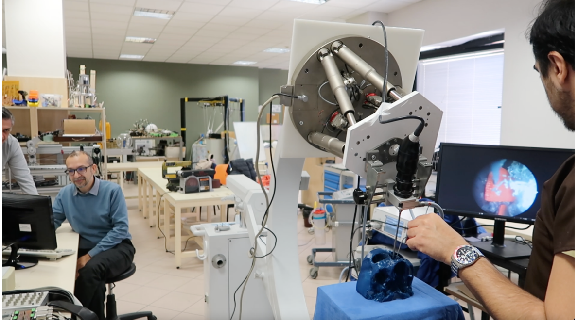
Şekil 20. Robotik kol ve kafatası modeli ile cerrahi çalışma düzeni
