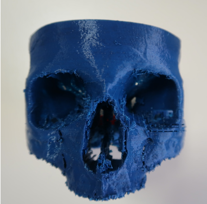
Şekil 14. 3 boyutlu yazıcıdan çıkartılan ön kafa tabanı (sfenoid kemik) maketi
