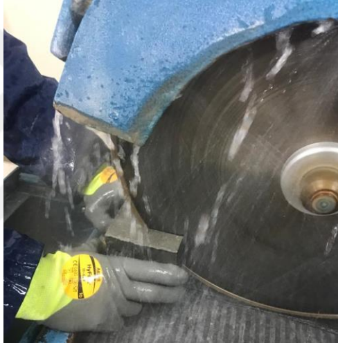
řekil 3.26. retilen betonların bhme ařınma deneyi iin kesilmesi
