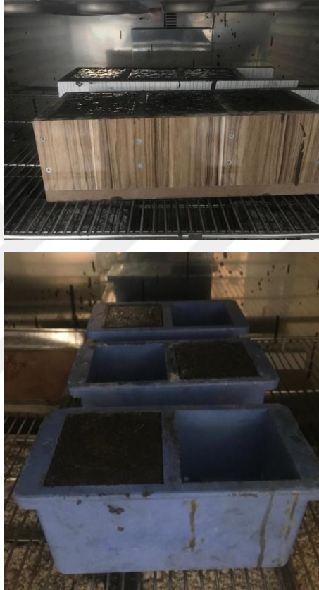
Şekil 3.10. Geopolimer harç ve betonlara ısıll kür uygulaması
