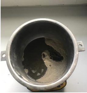
Adım 4: Kuru karışıma aktivatör eklenmesi
