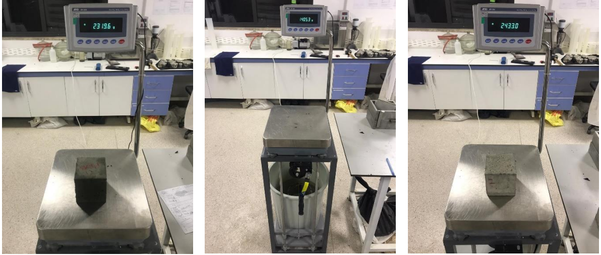
a: suya doygun havada ağırlık b: su içerisinde asılı ağırlık c: etüv kurusu ağırlık
