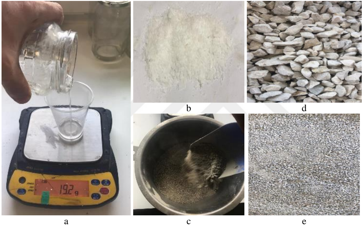
Şekil 3.2. Çalışmada kullanılan malzemeler (a: sodyum silikat, b: sodyum hidroksit, c: uçucu kül, d: iri agrega, e: ince agrega)
