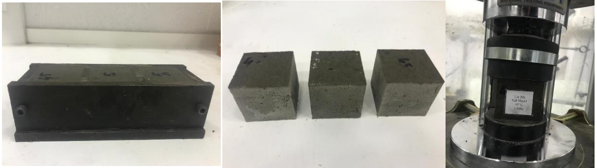
Şekil 3.9. Farklı sıcaklık değerlerinde kürlenmiş geopolimer harçların kalıptan çıkarılması ve dayanımlarının belirlenmesi
