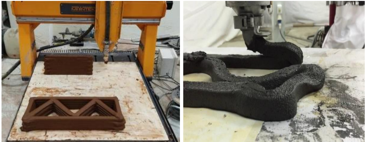
Şekil 2.9. 3D beton yazıcı ile geopolimer yapı üretimi (a: inşaat yıkıntı atıkları ile üretilen 3D geopolimer, b: geleneksel yöntemlerle üretilen 3D geopolimer) [71,72]
