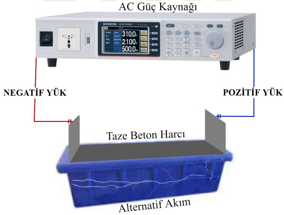
Şekil 2.17. Elektriksel kür deney düzeneği
