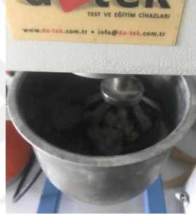
Adım 5: Geopolimer harcın çimento mikseri ile karıştırılması
