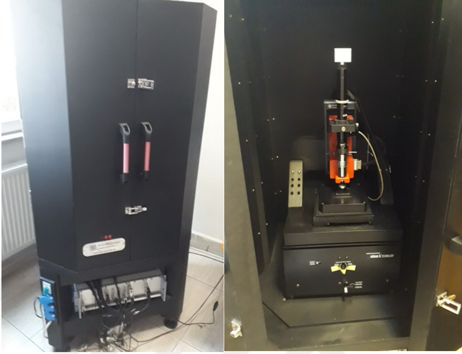
Şekil 3.5: NanoMagnetics Instruments LTD., Oxford, UK AKM Cihazı.
