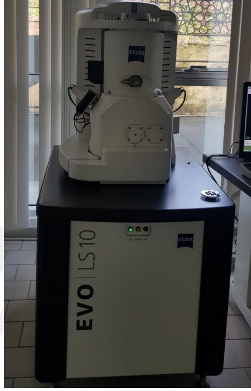
Şekil 3.8: Zeiss EVO LS 10 SEM-EDS cihazı.
