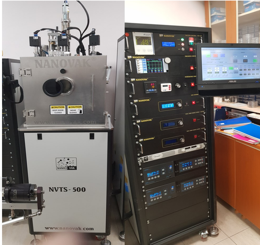
Şekil 3.3: Nanovak NVTs – 500 radyo-frekans magnetron sıçratma sistemi.
