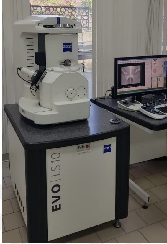
Şekil 3.7: Zeiss EVO LS 10 SEM cihazı.
