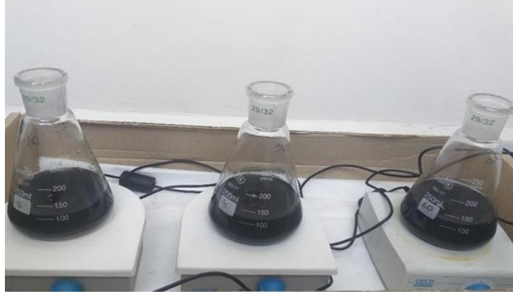
Şekil 3.4: SRT'nin adsorpsiyona etkisi deney düzeneği.
