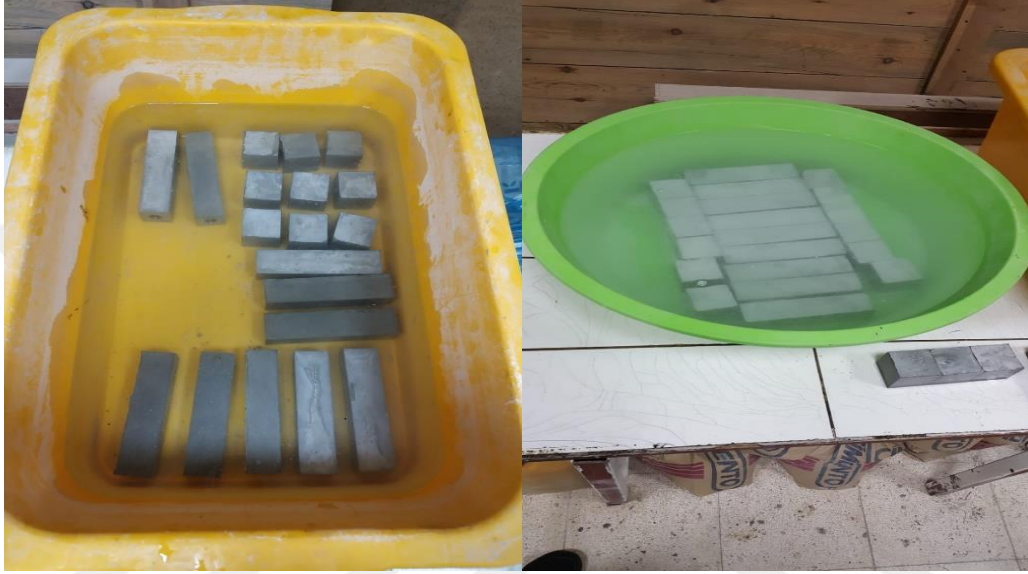
Şekil 3.7. Numunelerin kırım öncesi kürelemeye tabi tutulması
