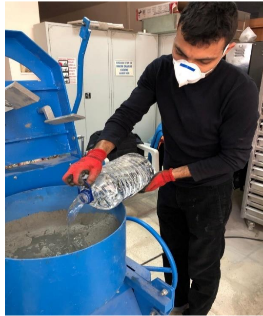
Şekil 3.15. Poroz içine dökülen optimum harcın hazırlanması
