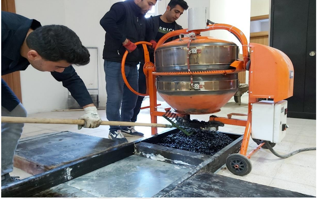
Şekil 3.12. Büyük hacimli poroz asfalt dökümü için mekanik mikser ve kalıp
