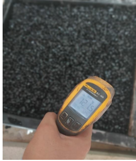
Şekil 3.14. Poroz asfalt dökümü sonrası sıkıştırma ve ısı takip işlemleri
