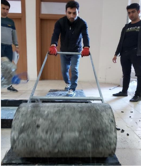
Şekil 3.14. Poroz asfalt dökümü sonrası sıkıştırma ve ısı takip işlemleri
