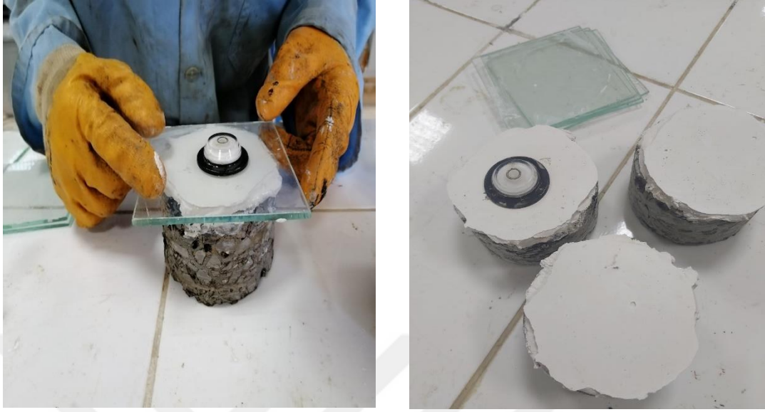
řekil 3.18. Basınç deneyi için numune yüzey hazırlığı
