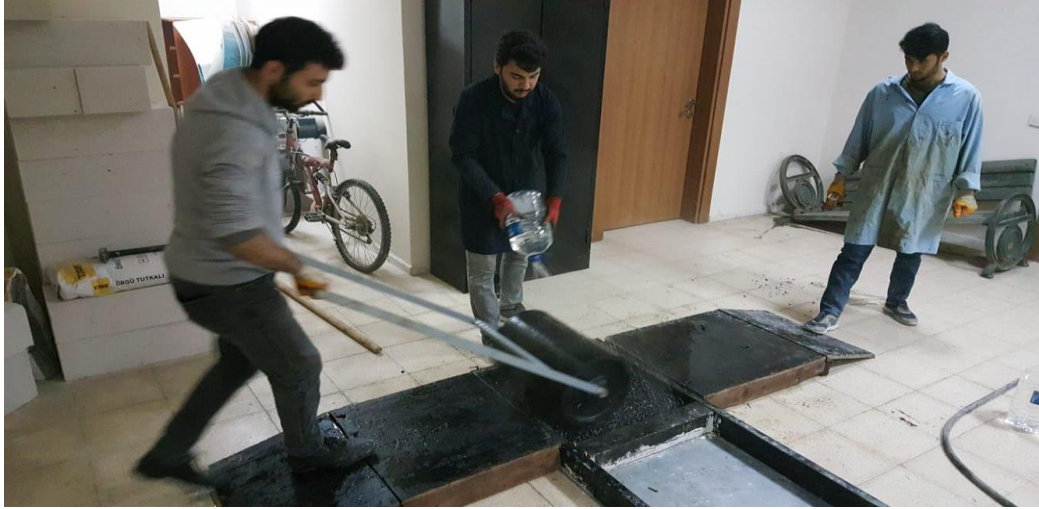
Şekil 3.13. Hazırlanan poroz asfaltın dökümü
