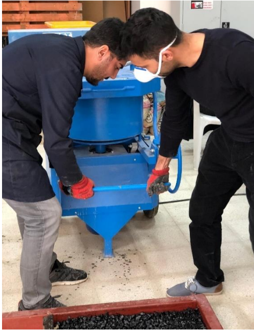
Şekil 3.15. Poroz içine dökülen optimum harcın hazırlanması
