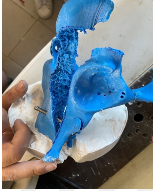
Şekil 27. PAO Ganz Osteotomisin Failure Hali
