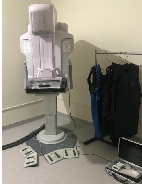
Şekil 3.1. IMS Giotto Class mamografi sisteminde tüp çıkışı ölçümü
