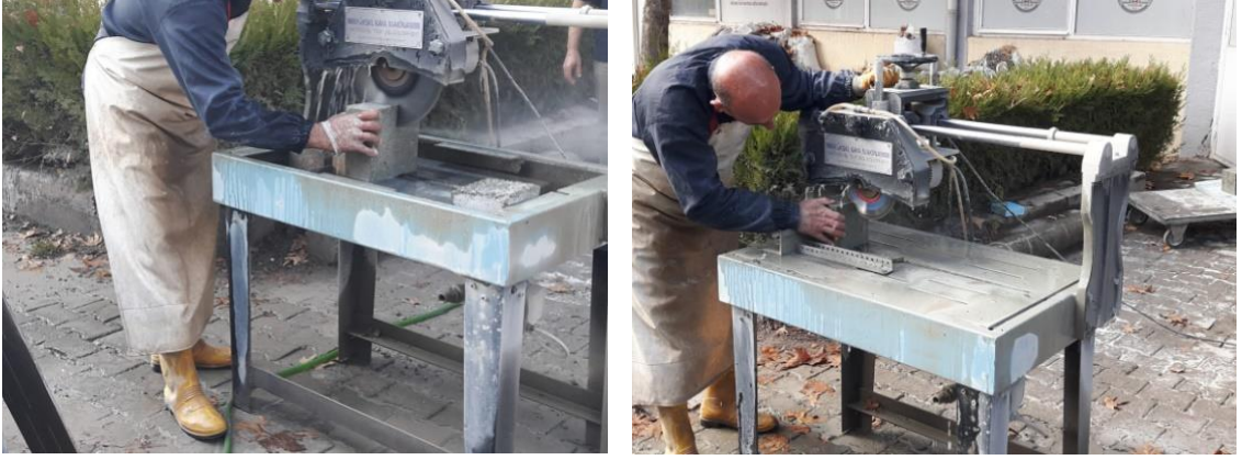
Şekil 4.9. Çentikli numune oluşturma
