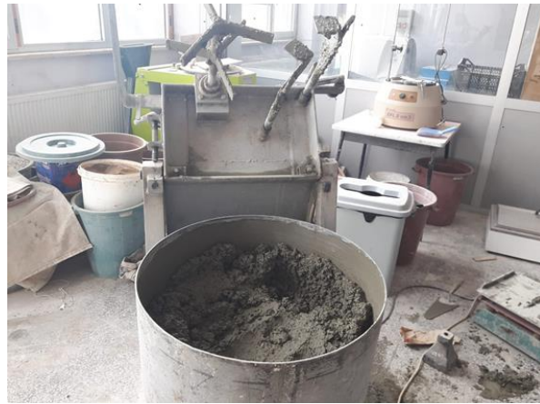
Şekil 4.6. Mikserde beton karışımının hazırlanması
