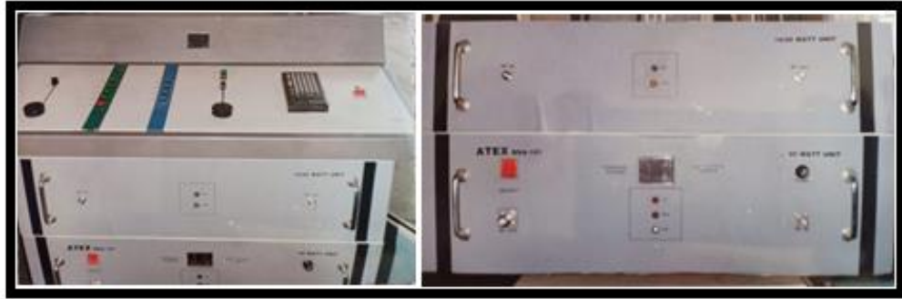
Şekil 3.35. Üretilen TV yayın masası ve BSA 101 TV vericisi (Sarıçam, 2022)
