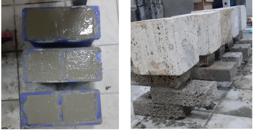
Şekil 3.20. ÇK1_3 oranlı harçtan alınan küp numune ve yapılan şaşırtmalı blok duvar numuneye ait görüntüler.
