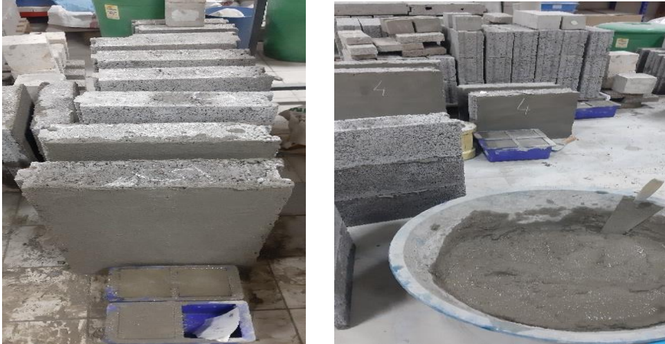
Şekil 3.24. ÇP1_3, ÇP1_4, ÇP1_5 ve ÇP1_7 sabit oranlı harçlarla ile hazırlanan 2'li ve 3'lü blok duvar numunelerine ait görüntüler.
