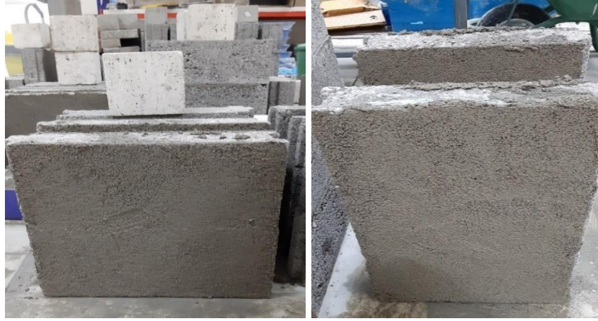
Şekil 3.26. ÇP1_5 ve ÇP1_7 oranlı harcı ile hazırlanan sıvalı 2'li ve 3'lü blok duvar numunelerine ait görüntüler.
