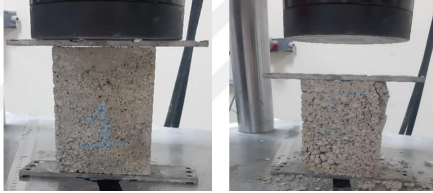
Şekil 3.13. 50*100*200 mm boyutlarındaki dolu blok bims numunelerin basınç dayanımı deneyine ait görüntüler.
