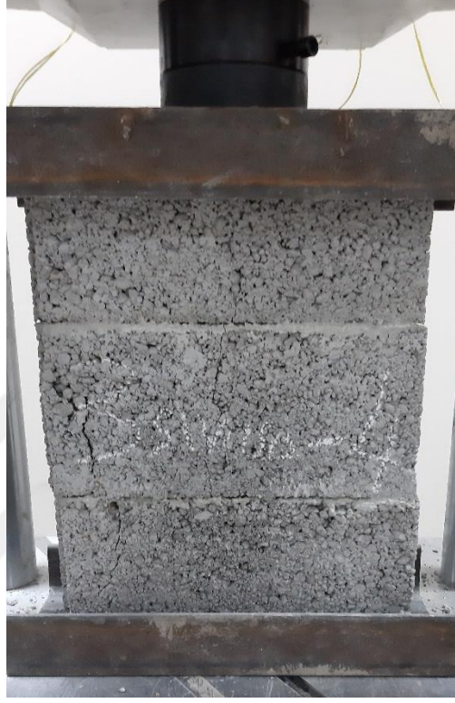
Şekil 4.20. ÇK1_3 harcı kullanılarak imal edilen 3'lü sıvasız blok numunelerin basınç dayanım deneyi sonu örnek görüntüleri.
