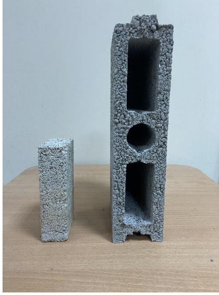
Şekil 3.3. Çalışma kapsamında kullanılan blok bims numuneler
