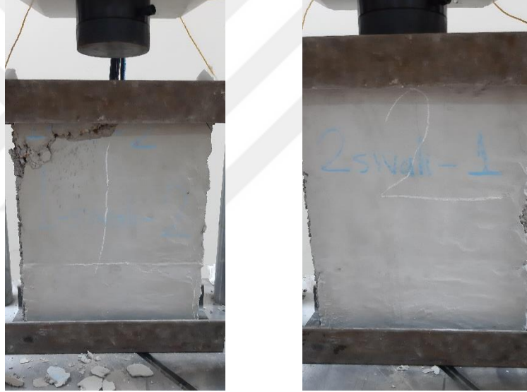
Şekil 4.24. K-Fix_İ ve K-Fix_K yapıştırma harcı kullanılarak imal edilen 3'lü sıvalı blok numunelerin basınç dayanım deneyi sonu örnek görüntüleri.
