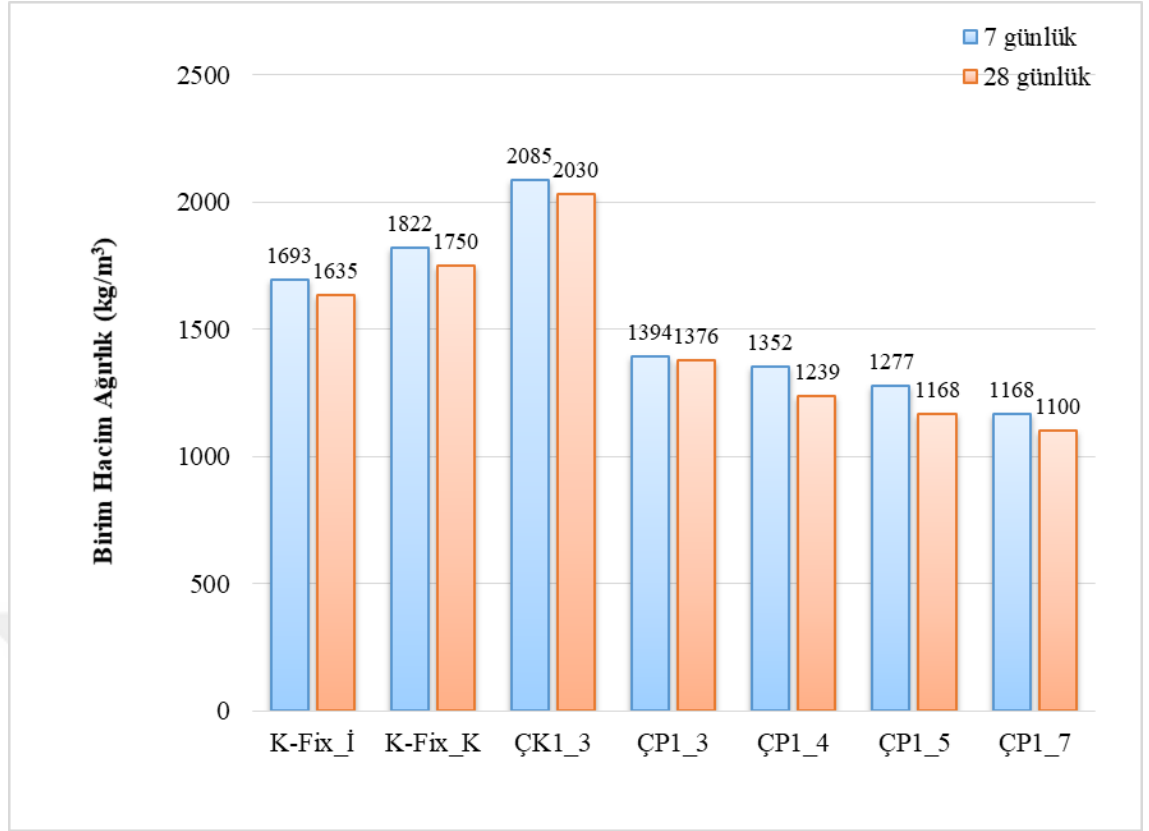
Şekil 4.1. Duvar blok numune imalatlarında kullanılan harçların 7 ve 28 gün sonundaki birim hacim ağırlıkları.
