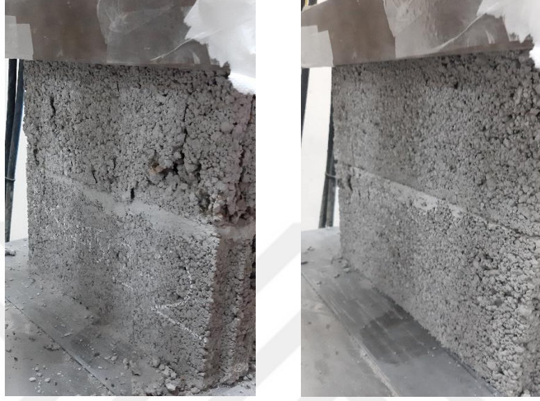
Őekil 4.12.  P1_5 ve  P1_7 harcı kullanılarak imal edilen 2'li sıvasız blok numunelerin basın  dayanım deneyi sonu  rnek g r nt leri.
