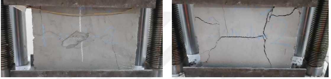
Őekil 4.14. K-Fix_İ ve K-Fix_K yapıŐtırma harcı kullanılarak imal edilen 2'li sıvalı blok numunelerin basınç dayanım deneyi sonu örnek görüntüleri.
