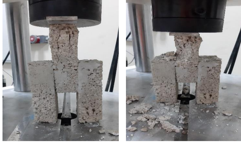
Şekil 4.5. K-Fix_İ ve K-Fix_K harcı ile yapılan şaşırtmalı blok duvar numunelerinin kesme direnci tayini deneyi sonrası.
