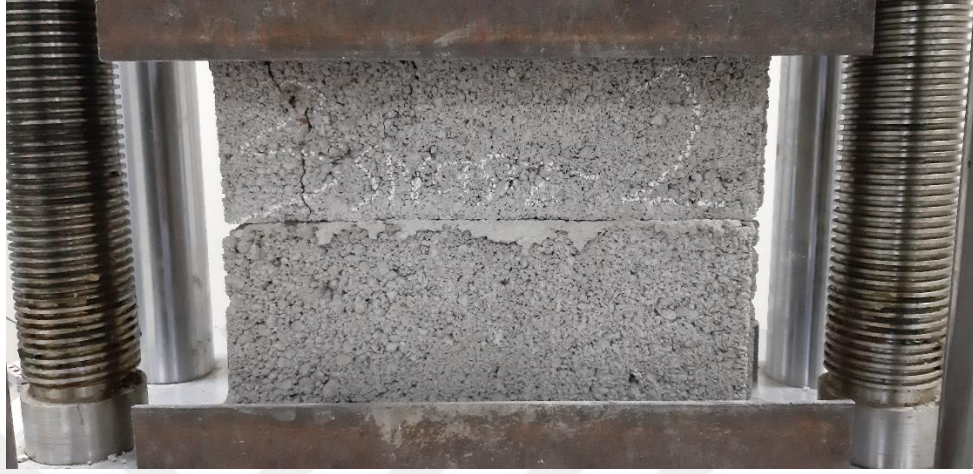
Şekil 4.10. ÇK1_3 harçlı kullanılarak imal edilen 2'li sıvasız blok numunelerin basınç dayanım deneyi sonu örnek görüntüleri.
