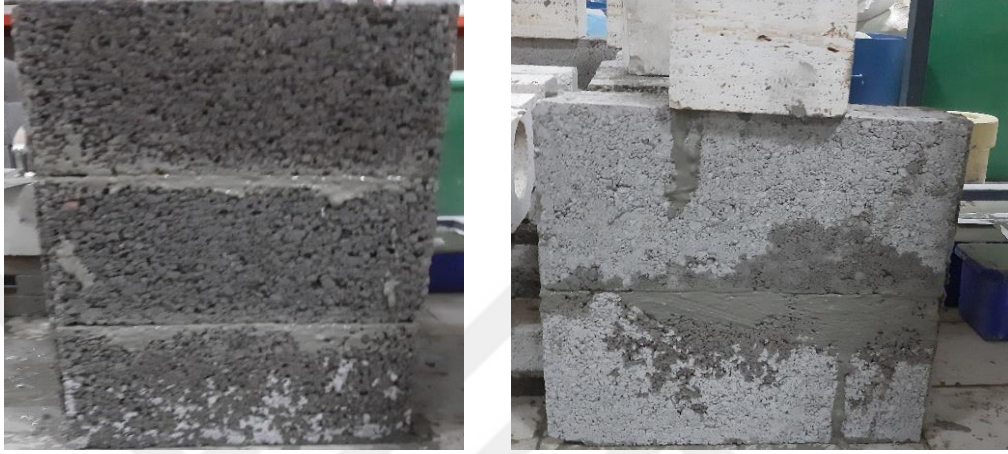
Şekil 3.17. K-Fix_İ ve K-Fix_K yapıştırma harcı ile hazırlanan 2’li ve 3’lü blok duvar numunelerine ait görüntüler.
