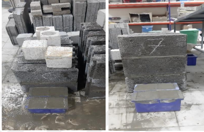
Şekil 3.25. ÇP1_5 ve ÇP1_7 sabit oranlı harçlarla ile hazırlanan 2'li ve 3'lü sıvasız blok duvar numunelerine ait görüntüler.
