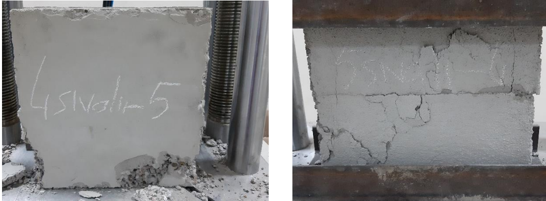
Şekil 4.16. ÇP1_3 ve ÇP1_4 pomza tozu harcı kullanılarak imal edilen 2'li sıvalı blok numunelerin basınç dayanım deneyi sonu örnek görüntüleri.
