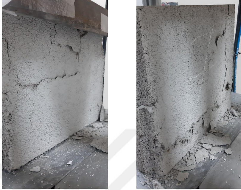
Şekil 4.17. ÇP1_5 ve ÇP1_7 pomza tozu harcı kullanılarak imal edilen 2'li sıvalı blok numunelerin basınç dayanım deneyi sonu örnek görüntüleri.
