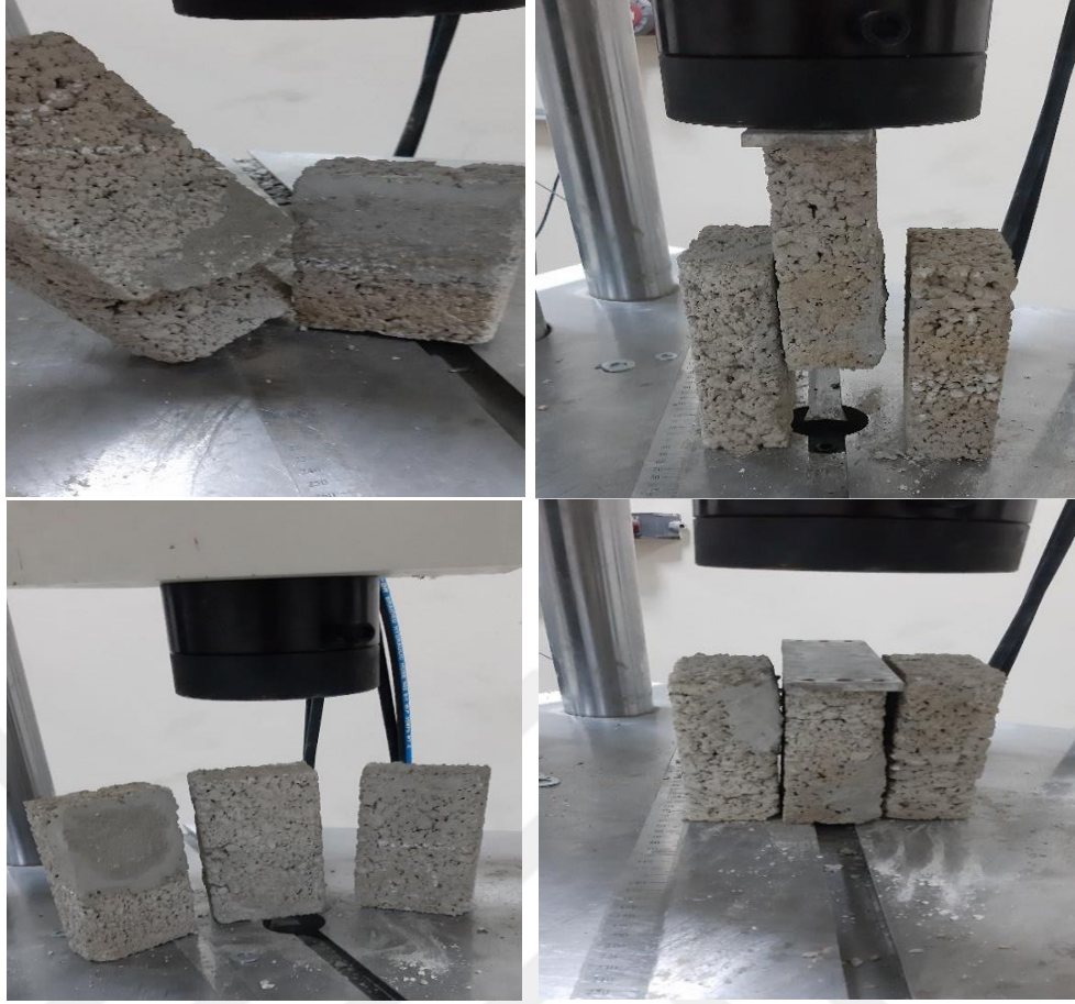
Şekil 4.7. Sırayla ÇP1_3, ÇP1_4, ÇP1_5 ve ÇP1_7 harçları ile yapılan şaşırtmalı blok duvar numunelerin kesme dayanımı deney sonu örnek görüntüleri.
