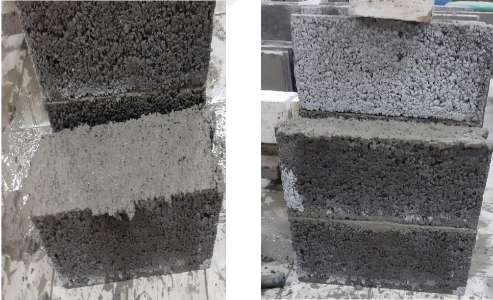
Şekil 3.21. ÇK1_3 oranlı harcı ile hazırlanan 2'li ve 3'lü blok duvar numunelerine ait görüntüler.
