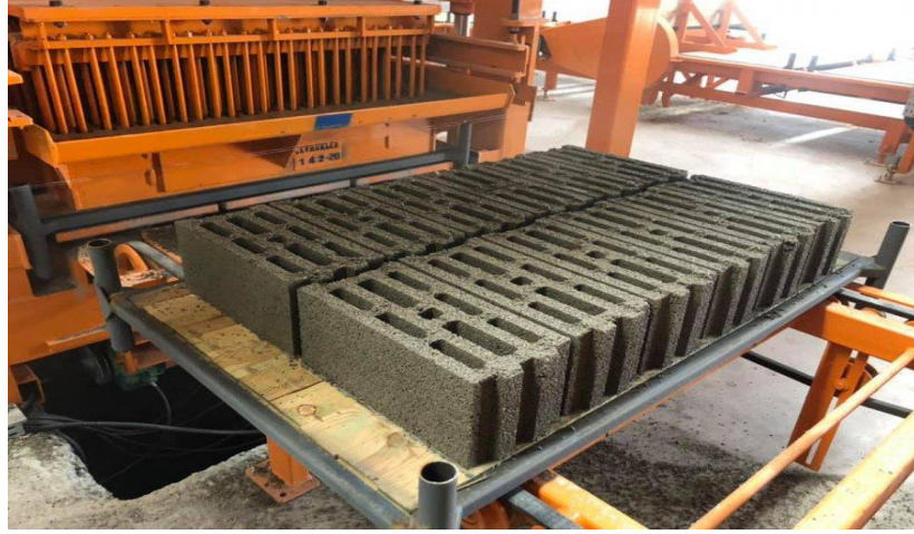
Şekil 1.6. Hafif yapı elemanı olan blokbims üretimi
