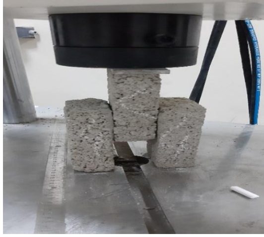
Şekil 3.30. Kesme direnci tayini deneyinden bir görüntü
