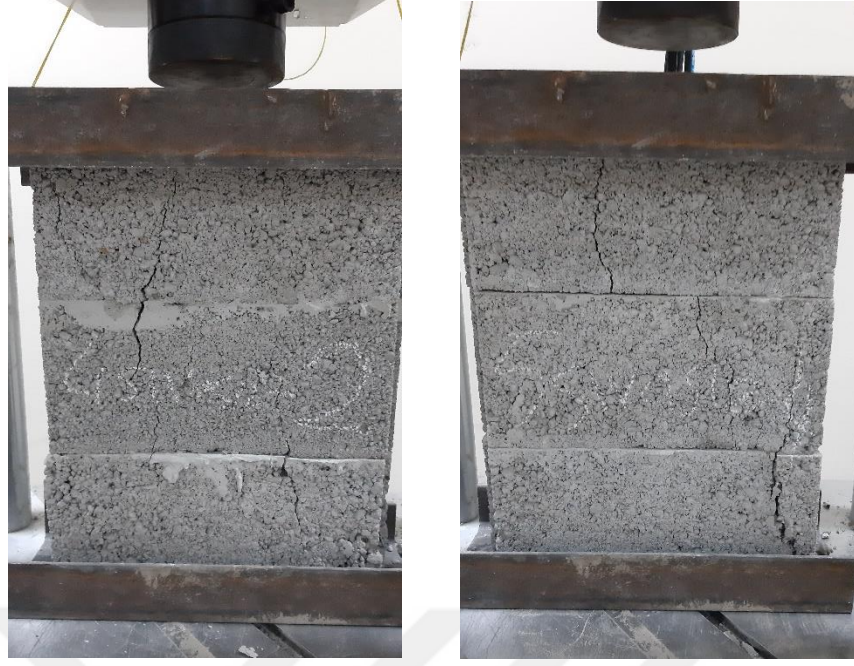
Şekil 4.21. ÇP1_3 ve ÇP1_4 harcı kullanılarak imal edilen 3'lü sıvasız blok numunelerin basınç dayanım deneyi sonu örnek görüntüleri.
