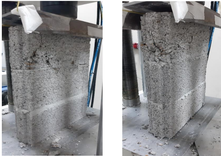
Şekil 4.22. ÇP1_5 ve ÇP1_7 harcı kullanılarak imal edilen 3'lü sıvasız blok numunelerin basınç dayanım deneyi sonu örnek görüntüleri.
