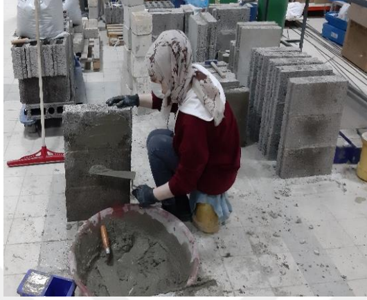
Şekil 3.22. ÇK1_3 oranlı harcı ile hazırlanan sıvalı 2’li ve 3’lü blok duvar numunelerine ait görüntüler.
