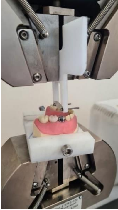
Resim 3.16. Universal test cihazı ile proksimal kontakt sıklığı ölçümü
