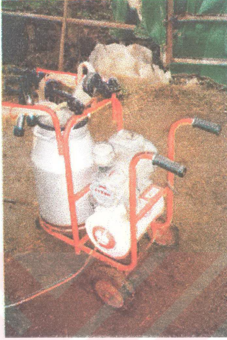
Şekil 4.19 Nabız Aygıtları Bakımsız Bir Süt Sağım Makinası
