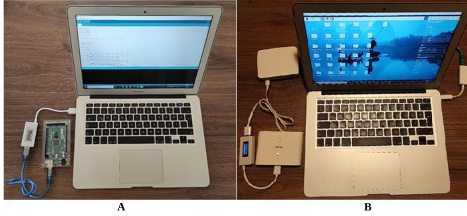
Şekil 3.15. Test edilen sistemin donanım düzeni (A, Arduino Mega kullanarak- B, Raspberry Pi kullanarak).
