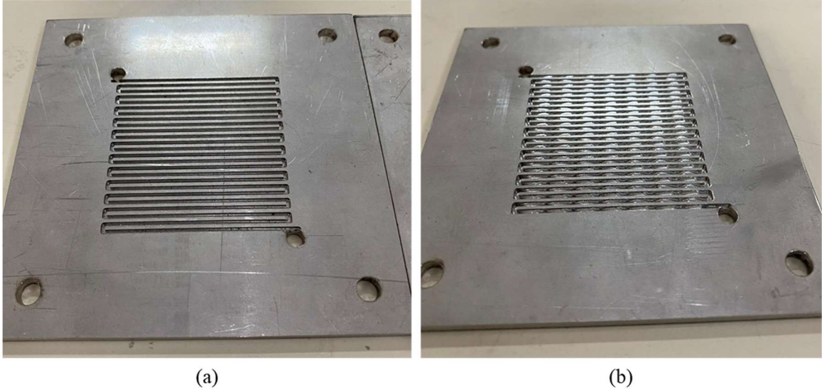
Şekil 5.13. CNC ile işlenen akış plakaları, (a) serpantin, (b) engele sahip plaka.
