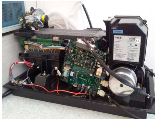
Şekil 2.3. Ticari olarak kullanılan örnek bir PEM yakıt pili yığını [56].
