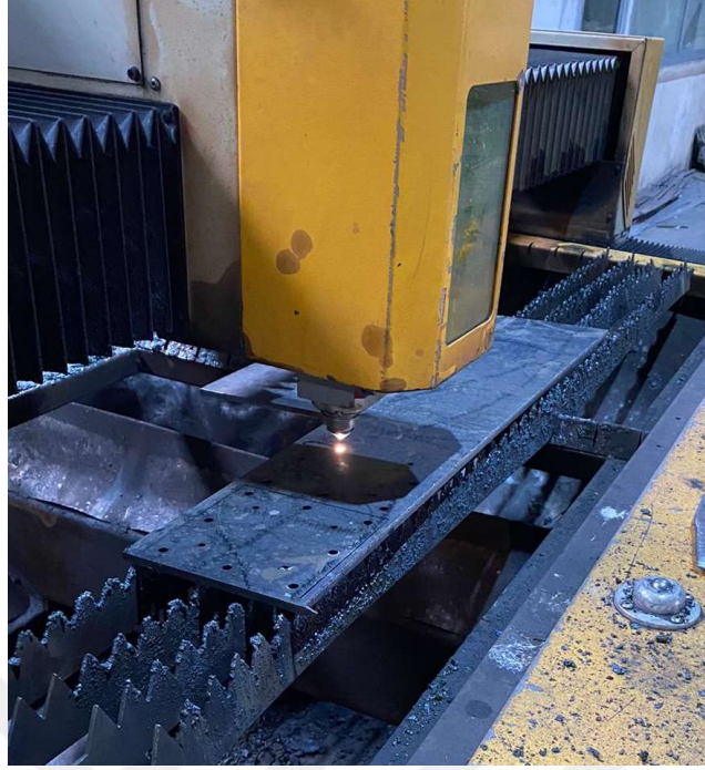
Şekil 5.14. Lazer kesim ile sıkıştırma plakalarının üretimi.
