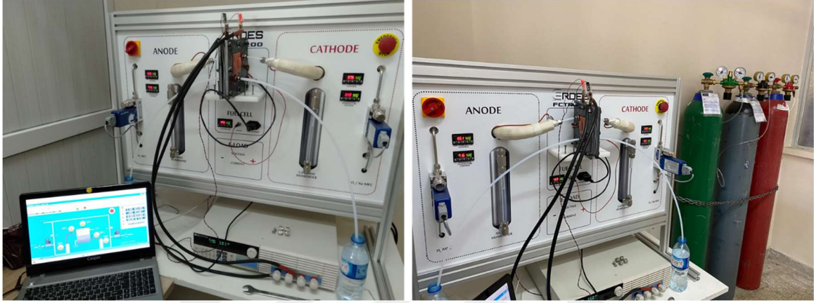
Şekil 5.18. Yakıt pili test düzeneği.
