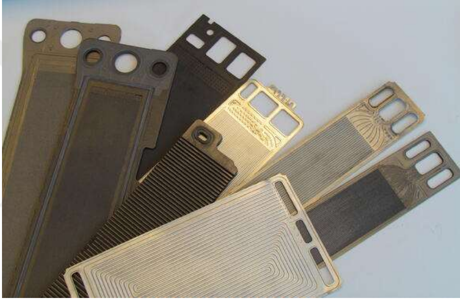
Şekil 3.1. Farklı malzeme ve tasarımlarda üretilmiş BPP'ler [84].
