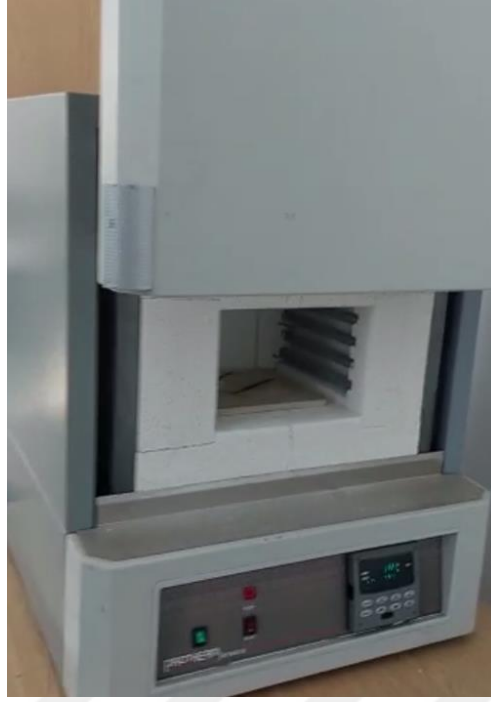
Şekil 2.2. Protherm programlanabilir kül fırını
