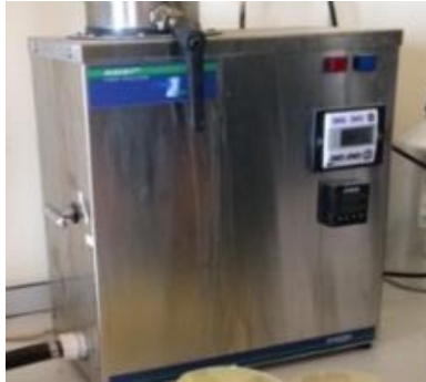
Şekil 3.11. ANKOM NDF/ADF lif analiz cihazı
