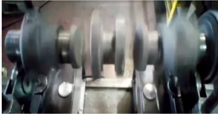
Şekil 5.3 Krank mili balans alma görseli
