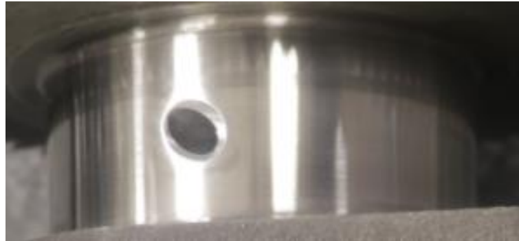
Şekil 5.2 Yağlama deliği görsel kontrolü
