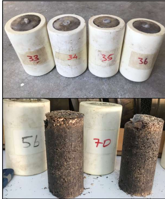
Şekil 4.45 : Jelleşmesini tamamlayan numunelerin moldlardan çıkarılması ve numaralandırılması.
