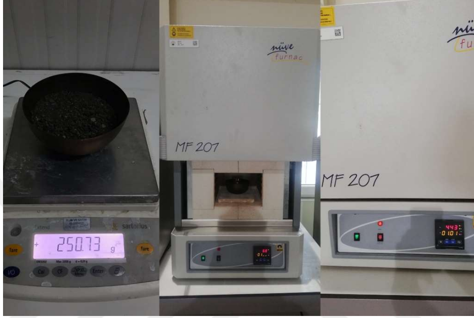
Şekil 4.10 : Organik madde tayini kütle ölçümü ve etüv sıcaklığı.
