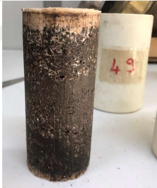
Şekil 4.47 : Jelleşmesini tamamlamış enjeksiyon malzemesinin numune içindeki görüntüsü.
