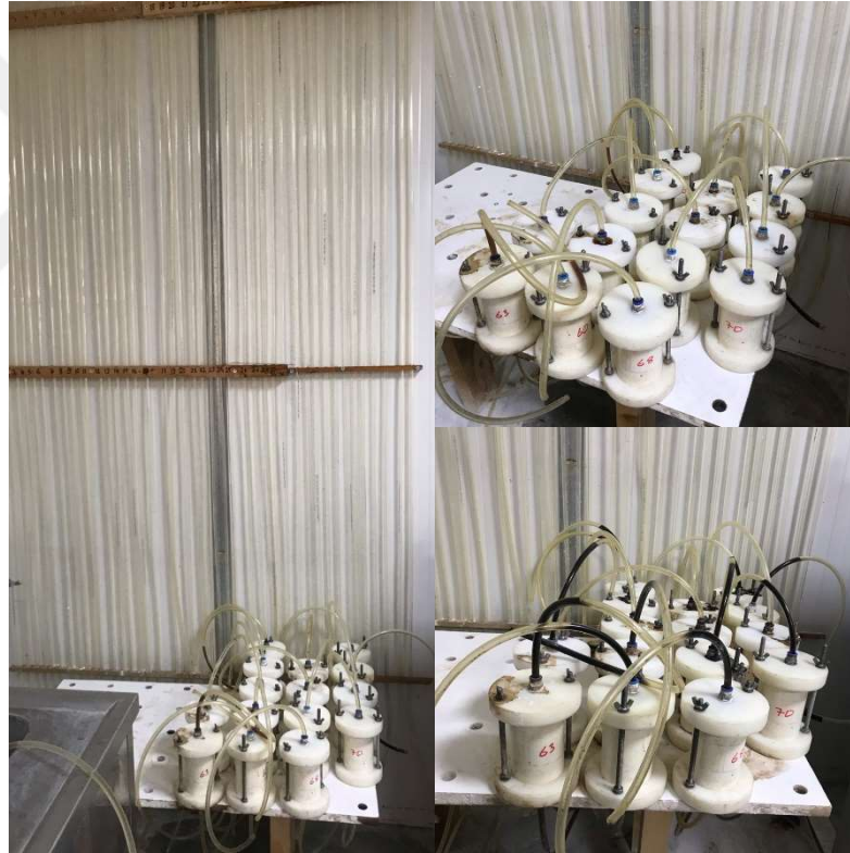
Şekil 4.61 : Düşen seviyeli permeabilite deney düzeneği ve numuneler.
