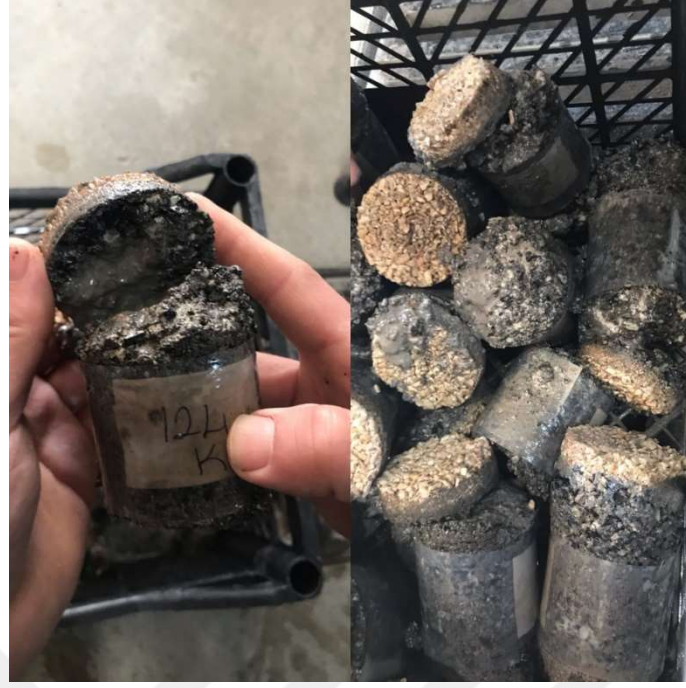
Şekil 4.50 : Kür havuzunda bütünlüğünü koruyamayan numuneler.
