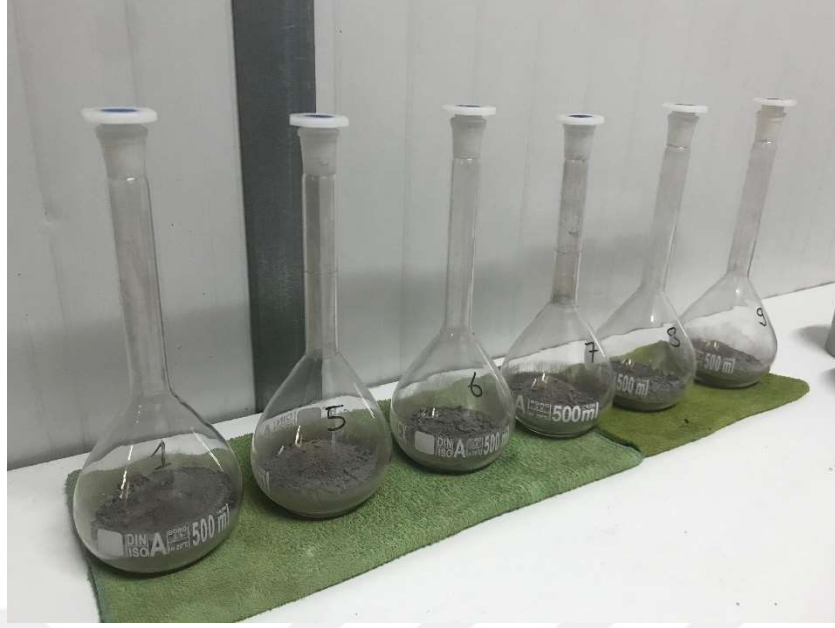
Şekil 4.3 : Piknometreye yerleştirilen zemin numuneleri.
