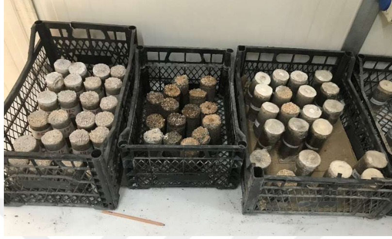
Şekil 4.48 : Açık ortamda ve streçte bekletilen numuneler.
