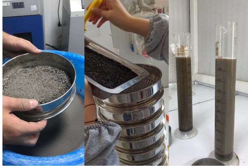
Şekil 4.5 : Elek analizi ve hidrometre deneyi aşamaları.
