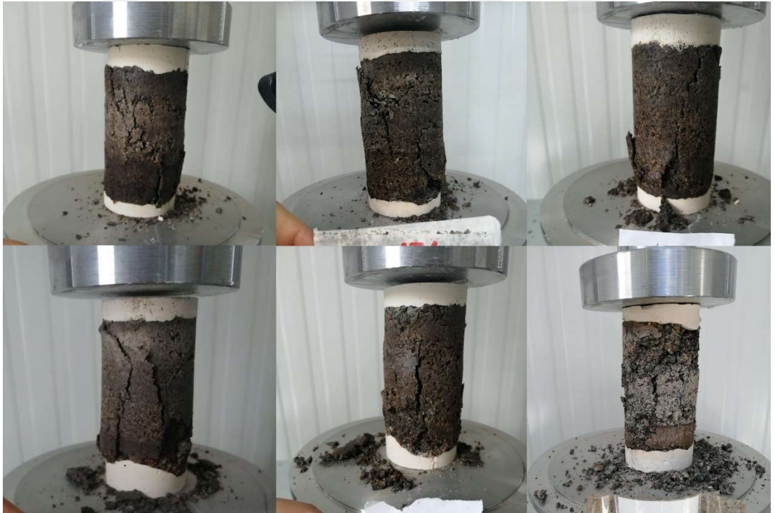
Şekil 4.60 : Serbest basınç dayanımı deneyi yapılan numunelerin tipik kırılma şekilleri.
