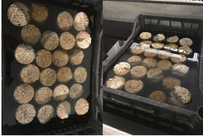
Şekil 4.49 : Kür havuzunda bekletilen numuneler.
