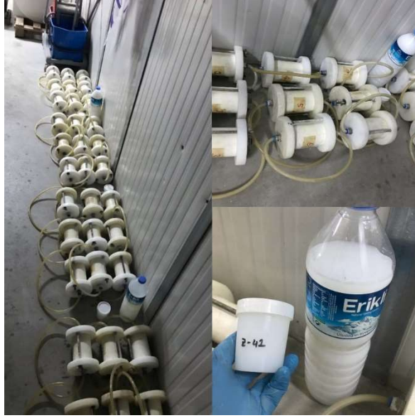
Şekil 4.44 : Enjeksiyon deneyi sonrası jelleşmenin beklenmesi.
