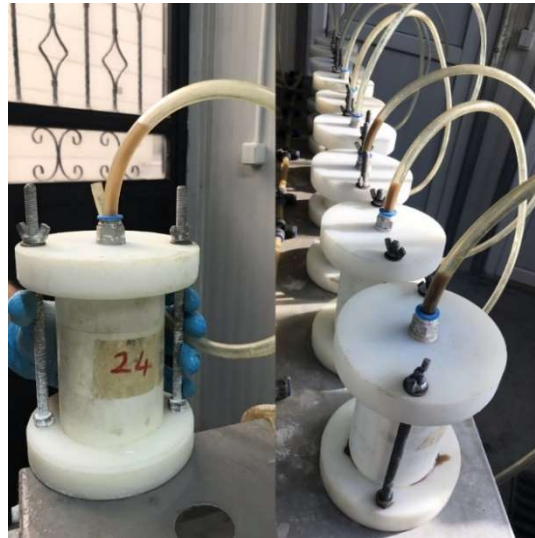
Şekil 4.43 : Enjeksiyon deneylerinin yapılması.
