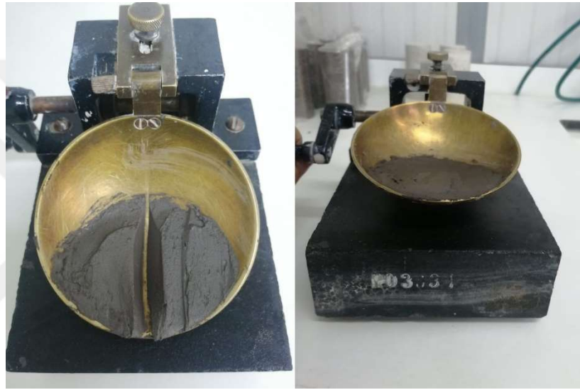
Şekil 4.7 : Casagrande deney cihazıyla likit limit deneyinin yapılması.
