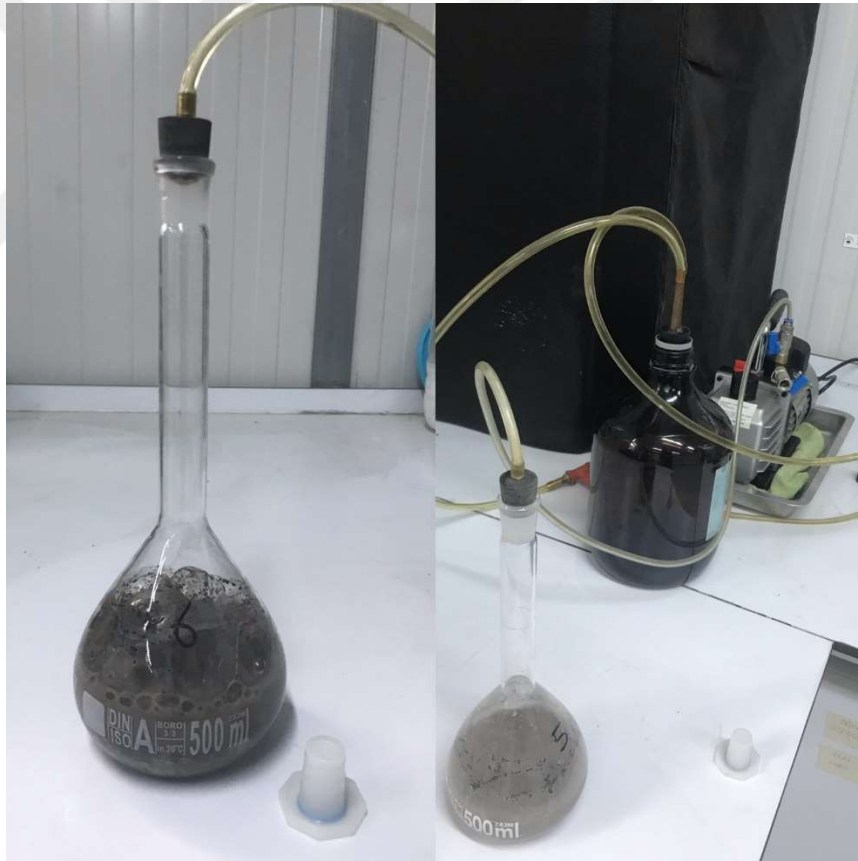
Şekil 4.4 : Vakum ile hava alma işlemi.
