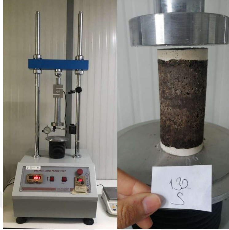
Şekil 4.53 : Serbest basınç dayanımı deneyinde kullanılan cihaz ve deneyin yapılışı.
