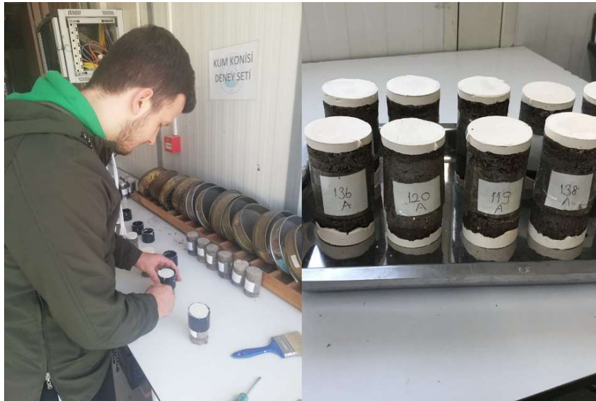
Şekil 4.51 : Numunelere başlık yapılması.
