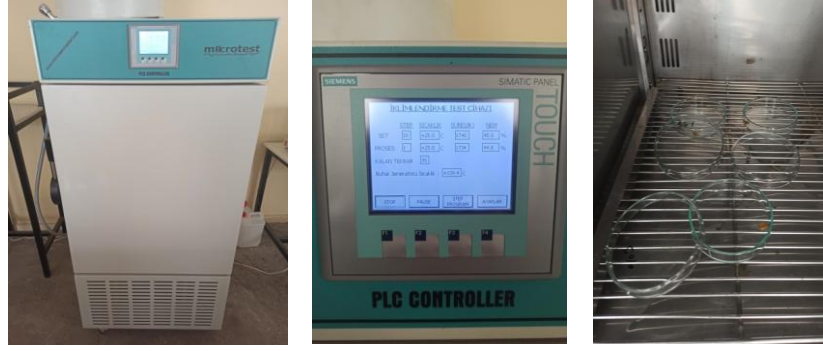
Şekil 2.8 İklimlendirme cihazı (SIEMENS MIT-120)
