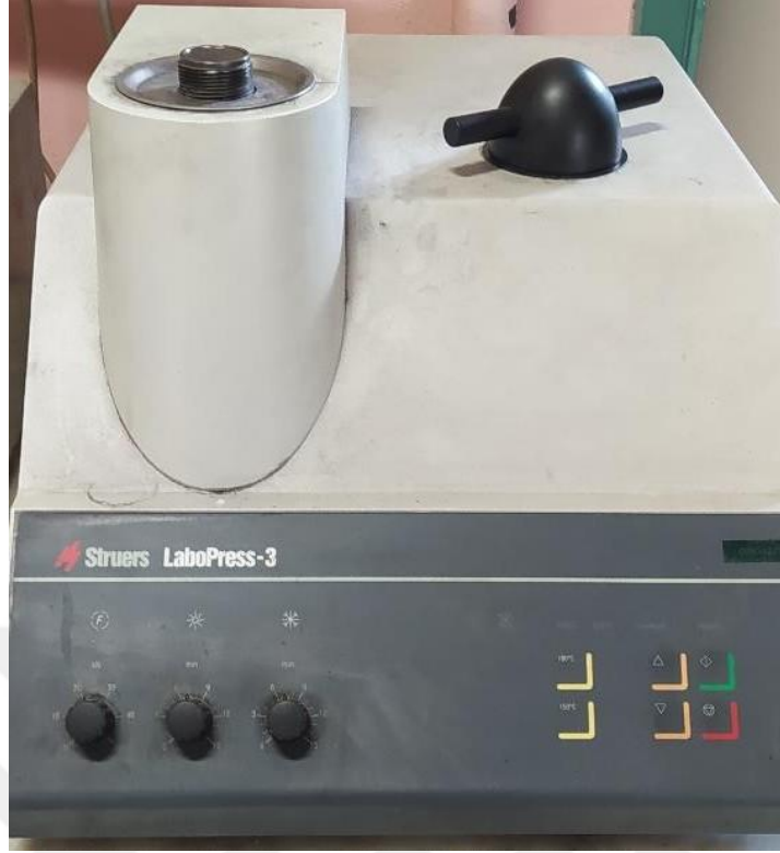
Şekil 3.6. Bakalite alma cihazı
