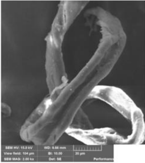
Resim 4.2. CNR SEM görüntüsü [53]
