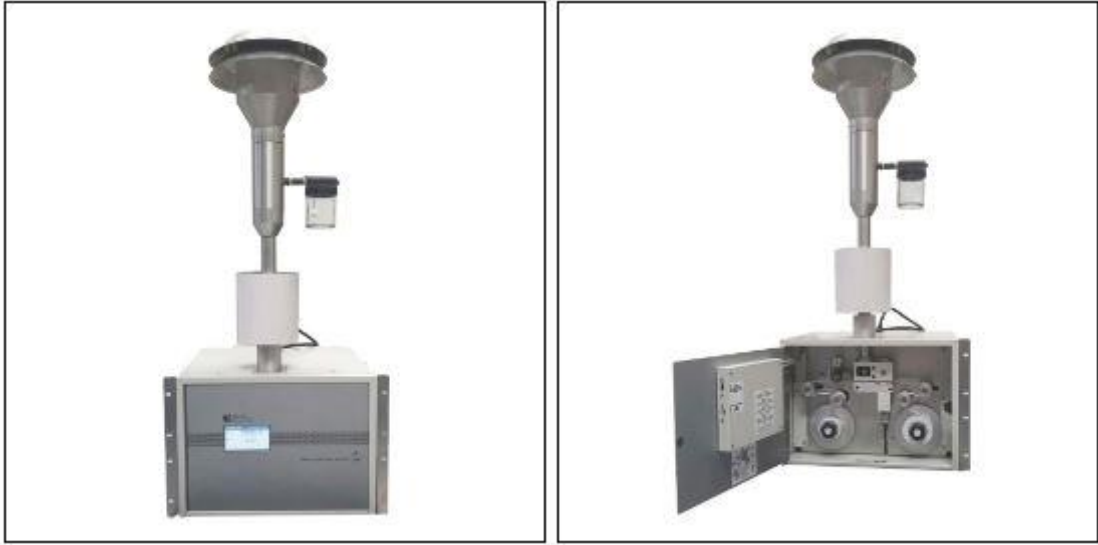
Şekil 34: Sürekli Partikül Monitörü BAM 1020 cihazı iç ve dış görünümü
