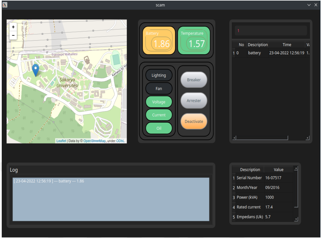
Şekil 4.5. Düşük batarya gerilimi uyarısına ait ekran görüntüsü.
