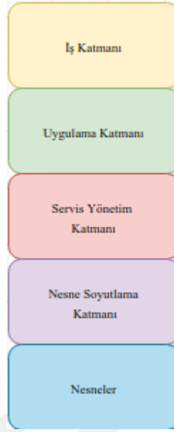
Şekil 2.1. Beş katmanlı Nİ mimarisi.
