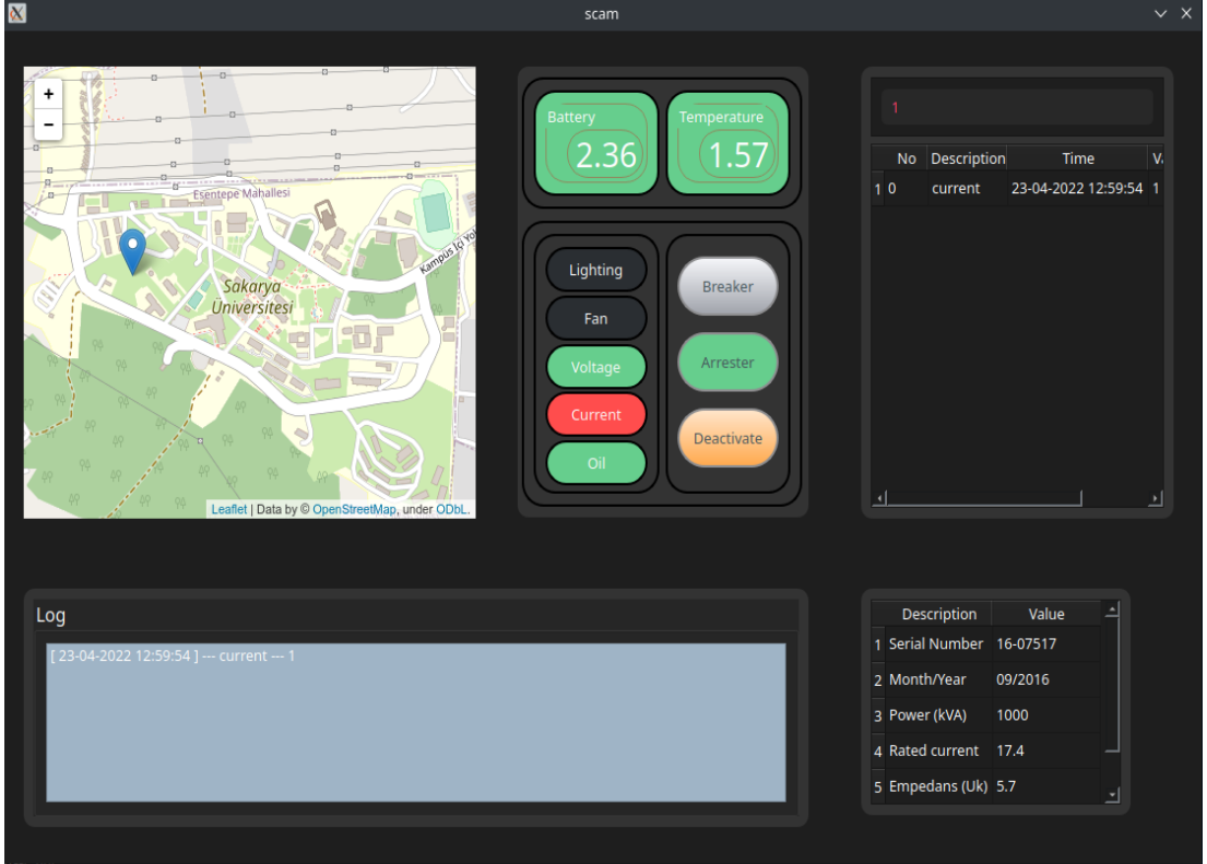
Şekil 4.6. Yüksek akım hatasının kullanıcıya bildirilmesine ait ekran görüntüsü.
