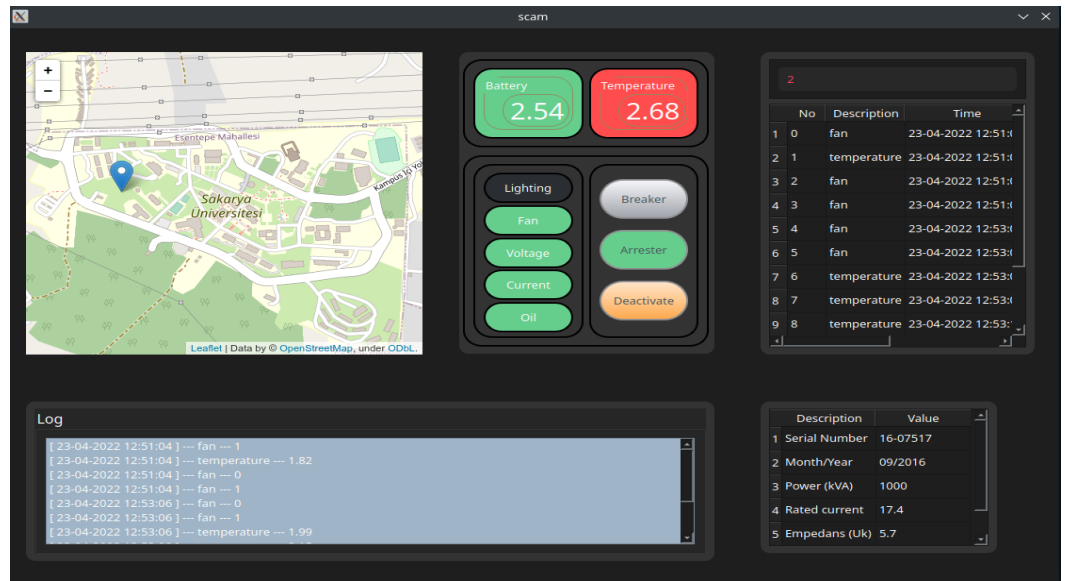
Şekil 4.9. Sıcaklığın artması ile birlikte kesicinin açtırılmasına ait görüntü.
