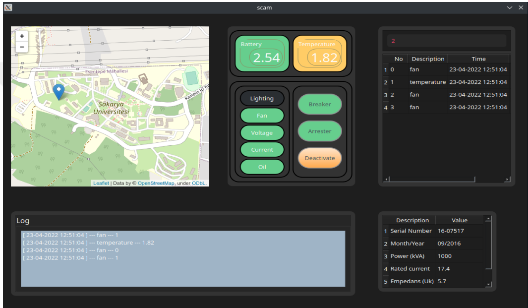
Şekil 4.8. Sıcaklığın artması ile birlikte fanın çalışmasına ait görüntü.
