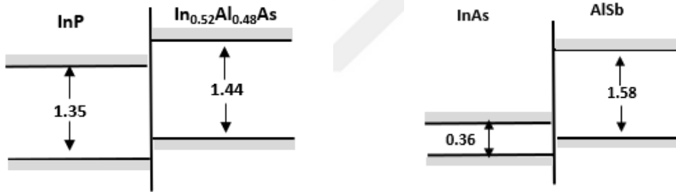
Şekil 3.4 Tip II heteroyapı sistemlerine ait önemli malzeme sistemlerinin şematik gösterimi (Frensley, 1994).
