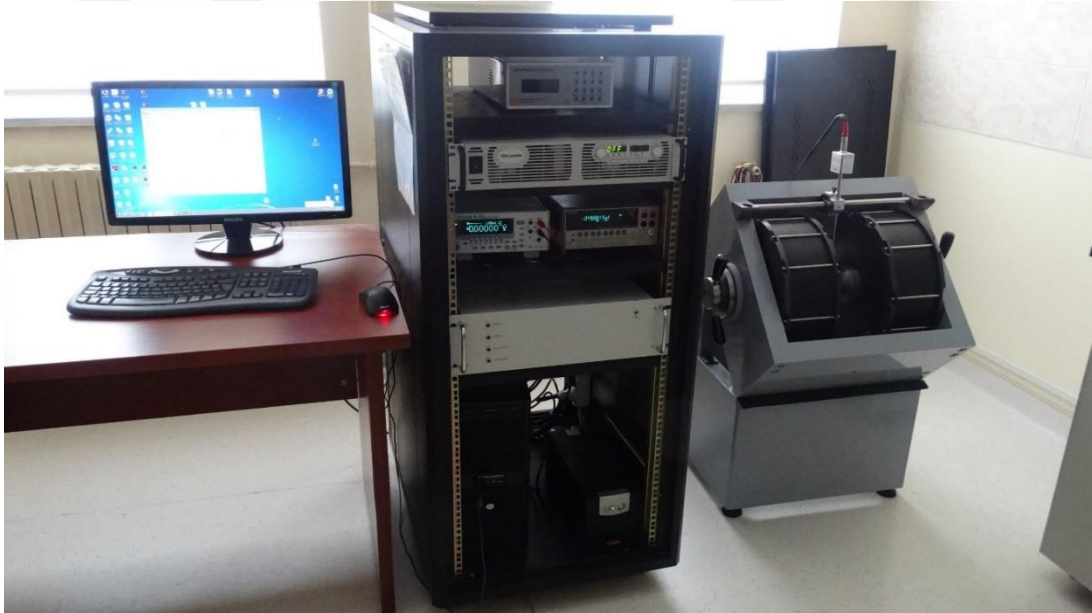
Şekil 4.10 Sivas Cumhuriyet Üniversitesi Nanofotonik Uygulama ve Araştırma Merkezi'nde kurulu bulunan Hall etkisi ölçüm sistemi.
