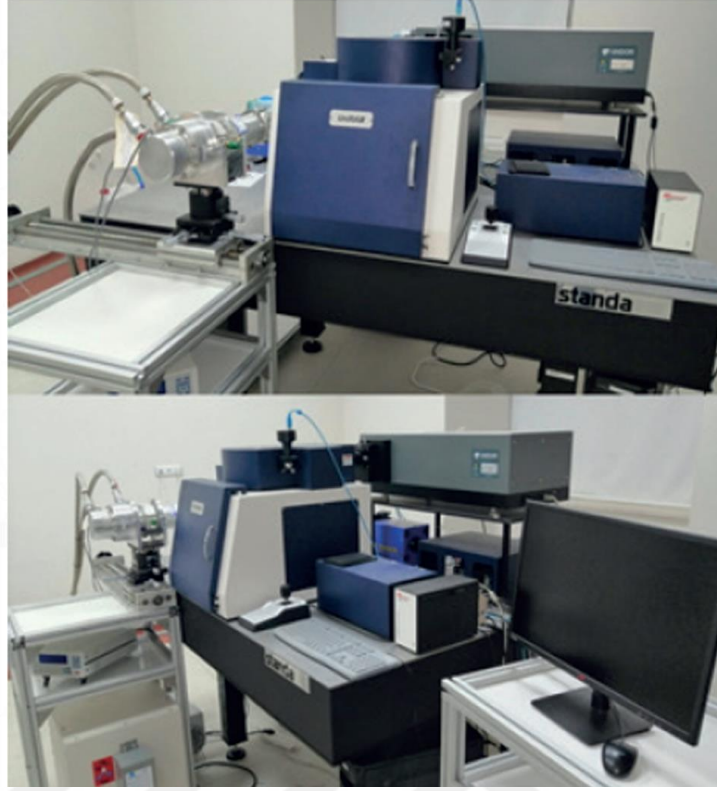
Şekil 4.13 Sivas Cumhuriyet Üniversitesi İleri Teknoloji Araştırma ve Uygulama Merkezi'nde kurulu bulunan fotolüminesans sistemi.
