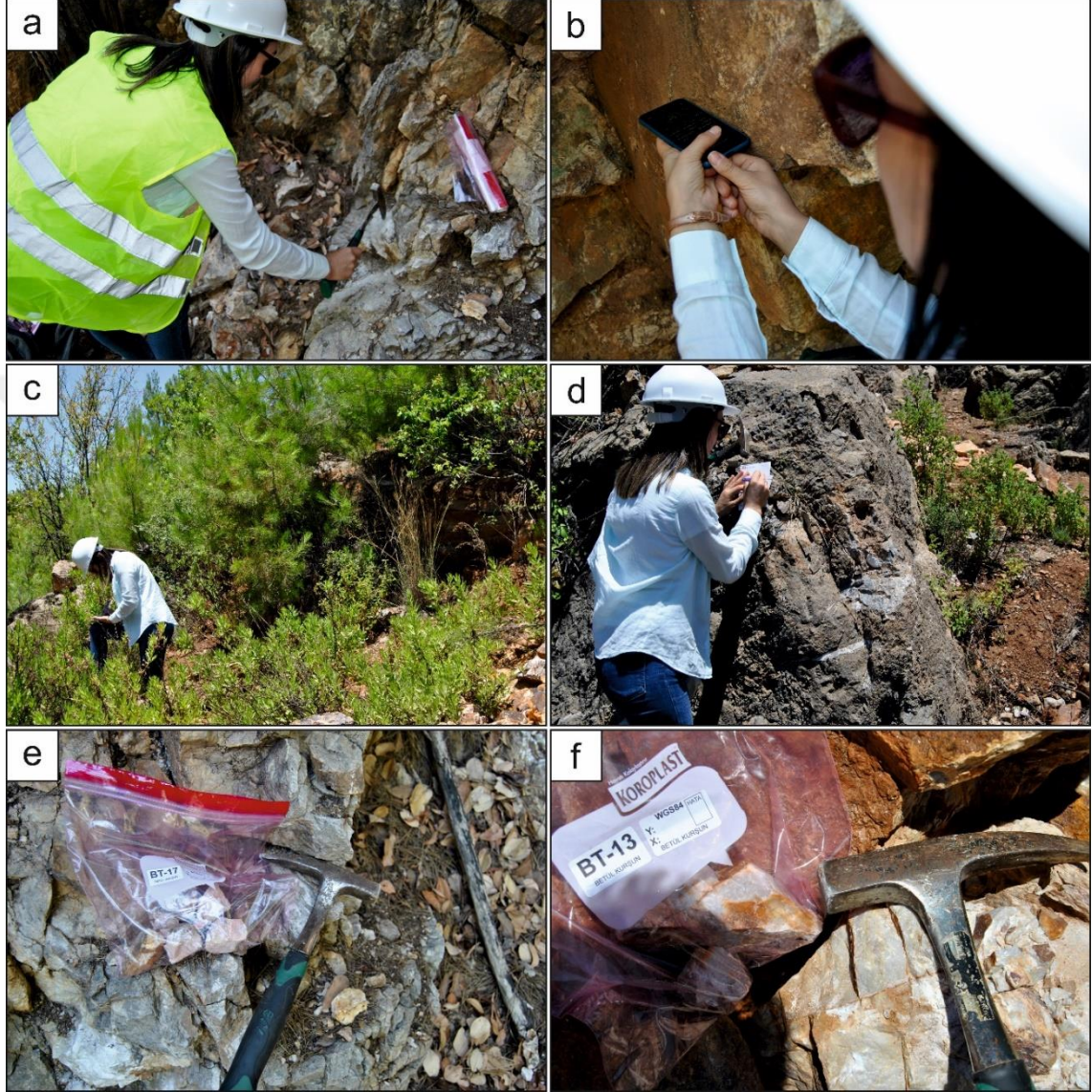
Şekil 3.7. a) Numune alımı; b, c, d) Tabaka doğrultu-eğim ve lokasyon ölçümleri; e, f) Numunelerin etiketlenip fotoğraflanması
