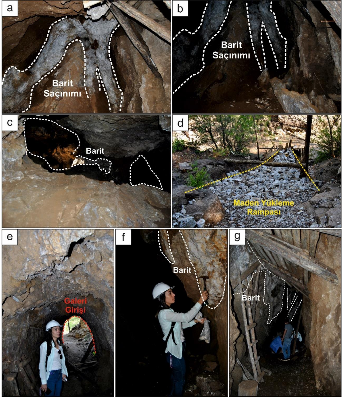
Şekil 3.4. a, b) Demirtaş bölgesi “Efe” barit ocağı galeri içi damar saçınımları; c) Galeride çıkarılmış barit damarları; d) Galeride çıkışı maden yükleme rampası; e) Galeride girişi; f, g) Galeride içi numune alımları
